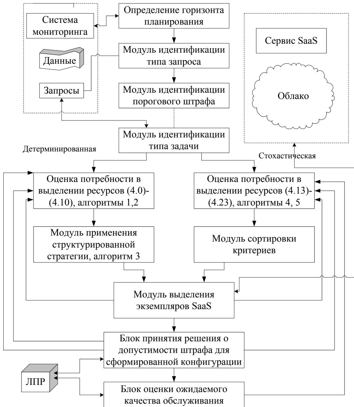
Рисунок 4.7. Структура и функции прототипа программного обеспечения оптимизации облачных сервисов SaaS для решения задач мониторинга
