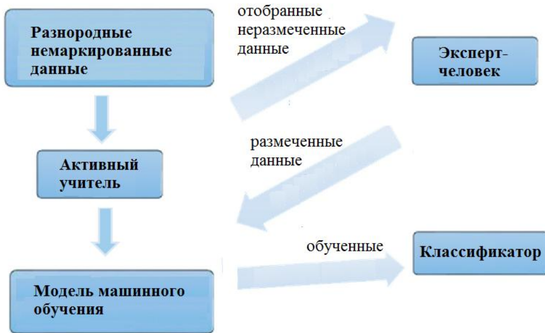
Рис. 4.2. Процесс активного машинного обучения для обработки немаркированных данных
