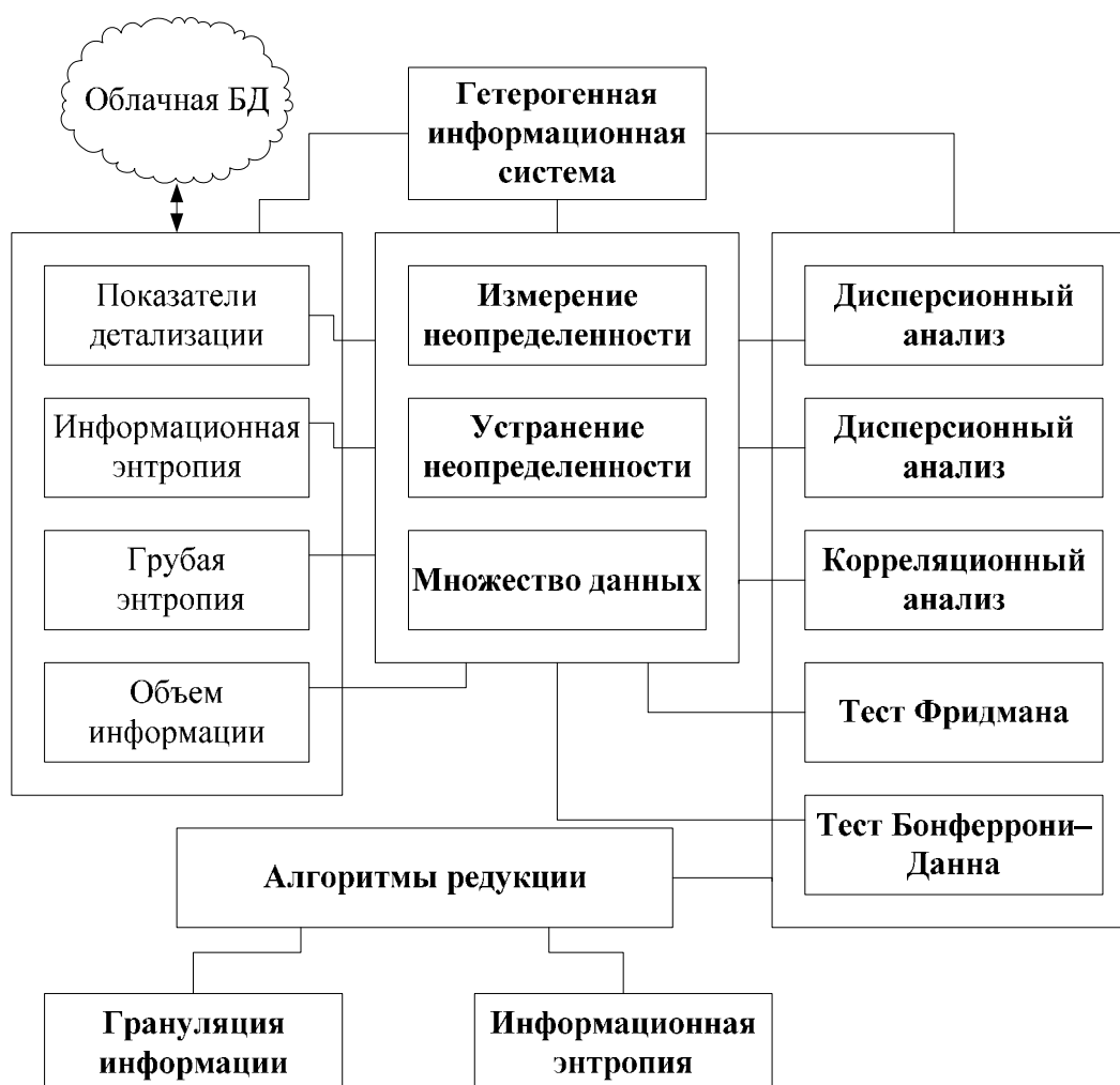
Рис. 3.5. Архитектура программной системы управления гетерогенной информационной системой
