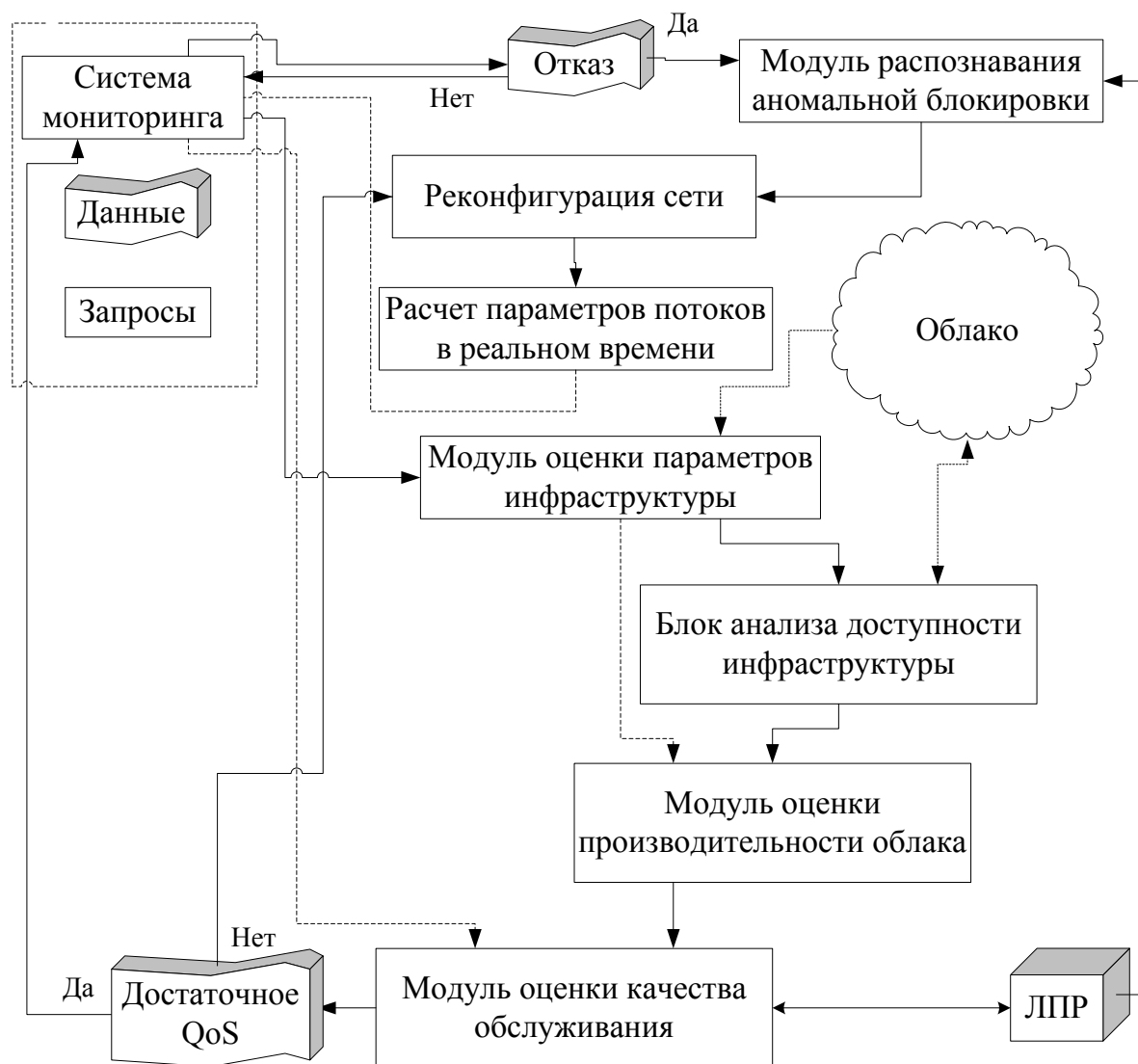
Рисунок 4.8. Структура и функции прототипа программного обеспечения распознавания блокировок и оптимизации доступности облачных сервисов
