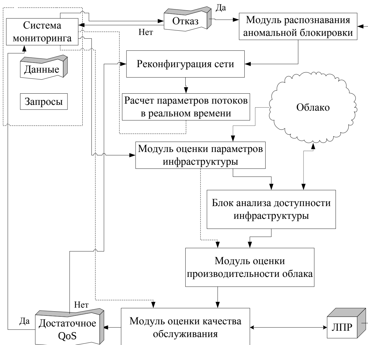
Рис. 13. Структура программного прототипа системы распознавания блокировок и оптимизации доступности облачных сервисов
