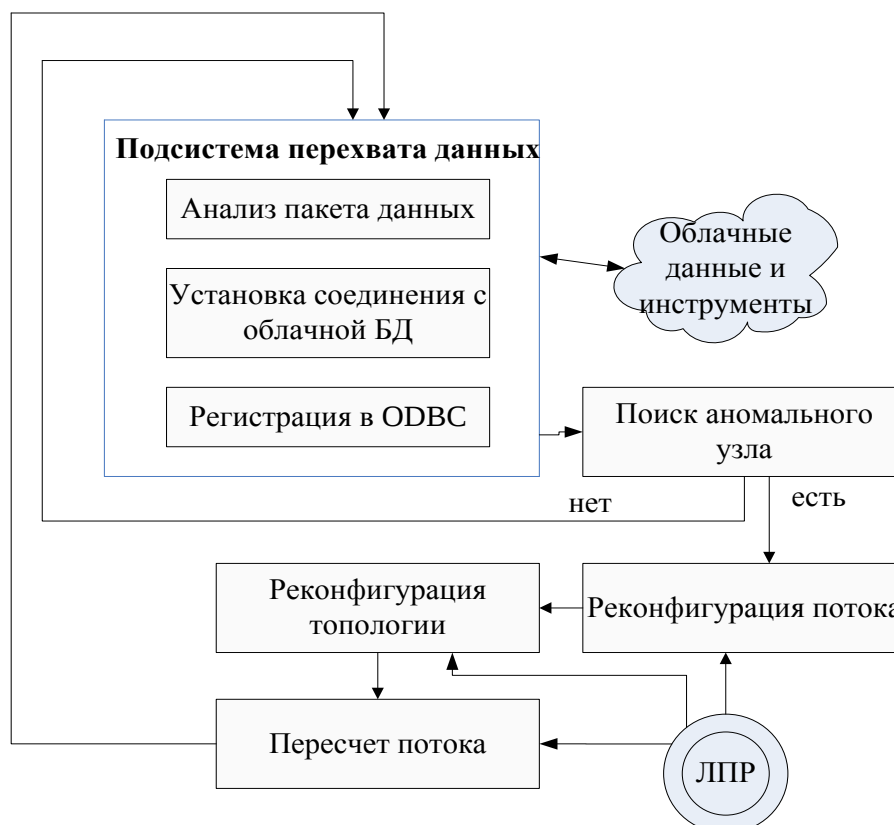
Рис. 11. Алгоритм идентификации состояния КС
