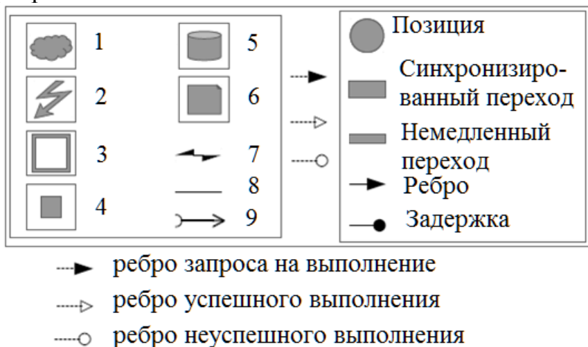
Рис. 4. Элементы GSPN, CDL и формализмы композиции: 1 – центр обработки данных; 2 – брокер; 3 – хост; 4 – виртуальная машина; 5 – память; 6 – cloudlet; 7 - ребро планирования пуска; 8 – ребро соединения; 9 – ребро рабочей нагрузки
