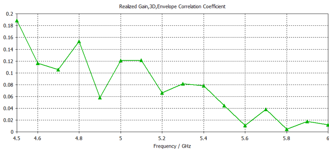
Рисунок 5.24 – Частотная зависимость коэффициента корреляции по огибающей для МЛА на основе двухуровневой линзы и ТЕМ-рупора
