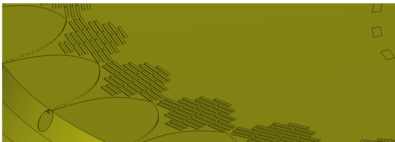
Рисунок 5.68 – Внешний вид фазокорректирующей метаматериальной линзы, размещаемой в раскрыве антенн Вивальди [282]
