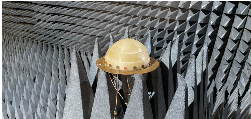
Рисунок 5.61 – Фотография макета разработанной МЛА
