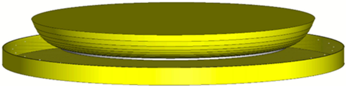
Рисунок 5.17 – Внешний вид МЛА на основе двухуровневой линзы и несимметричного ТЕМ-рупора
