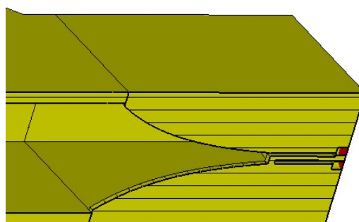
Рисунок 4.8 – Входной порт элемента ФАР, на основе Н-плоскостного рупора
