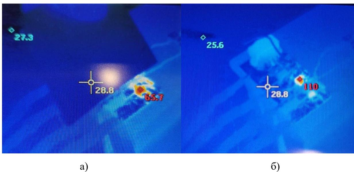
Рисунок 4.7 — Температура на верхнем (а) и нижнем (б) транзисторе в рабочем режиме
