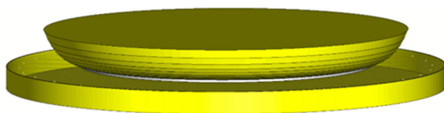
Рисунок 14 – МЛА основе двухуровневой линзы и несимметричного ТЕМ-рупора
