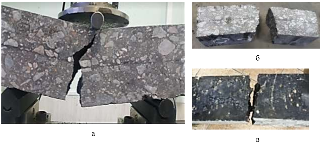
а – образец в опорном устройстве после завершения испытания; б – образец без армирующей прослойки из ГМ, в – образец с армирующей прослойкой из ГМ
