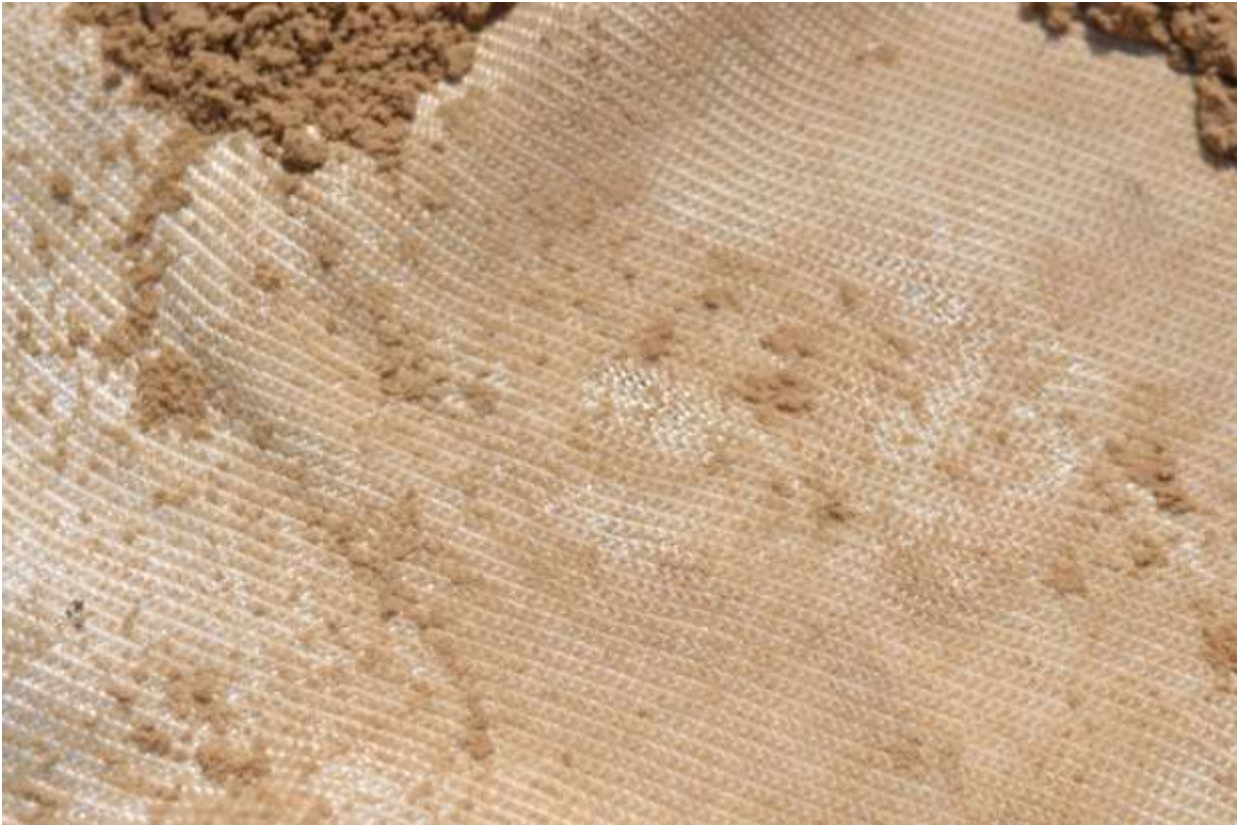
Рисунок 3.13 – Геополотно вязаное после извлечения из конструкции (песок-песок)
