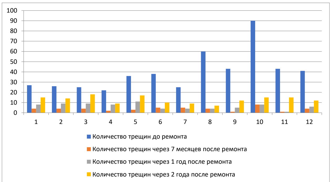
Рисунок 3.23 - Трещины на участках с геосинтетическим материалом
