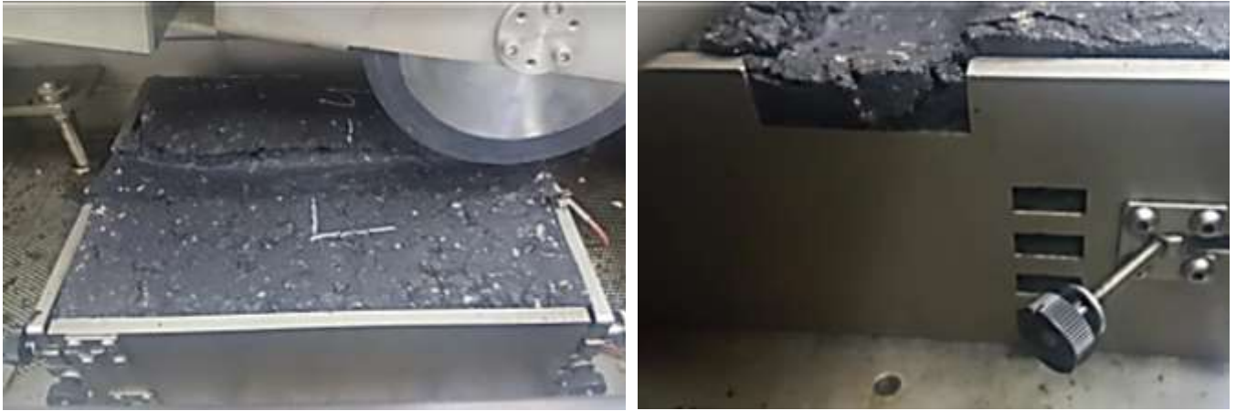
Рисунок 3.30 - Фото образцов-плиток с колеей
