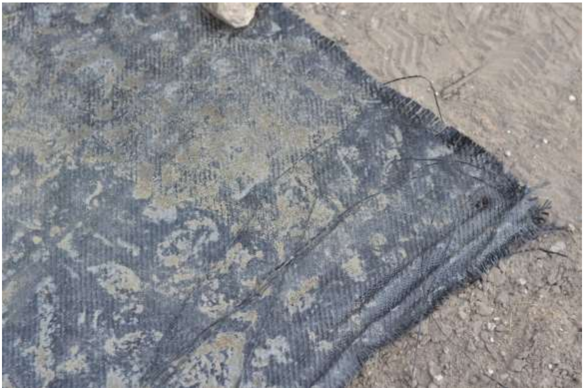
Рисунок 3.14 – Геополотно нетканое после извлечения из конструкции (песок-щебень)
