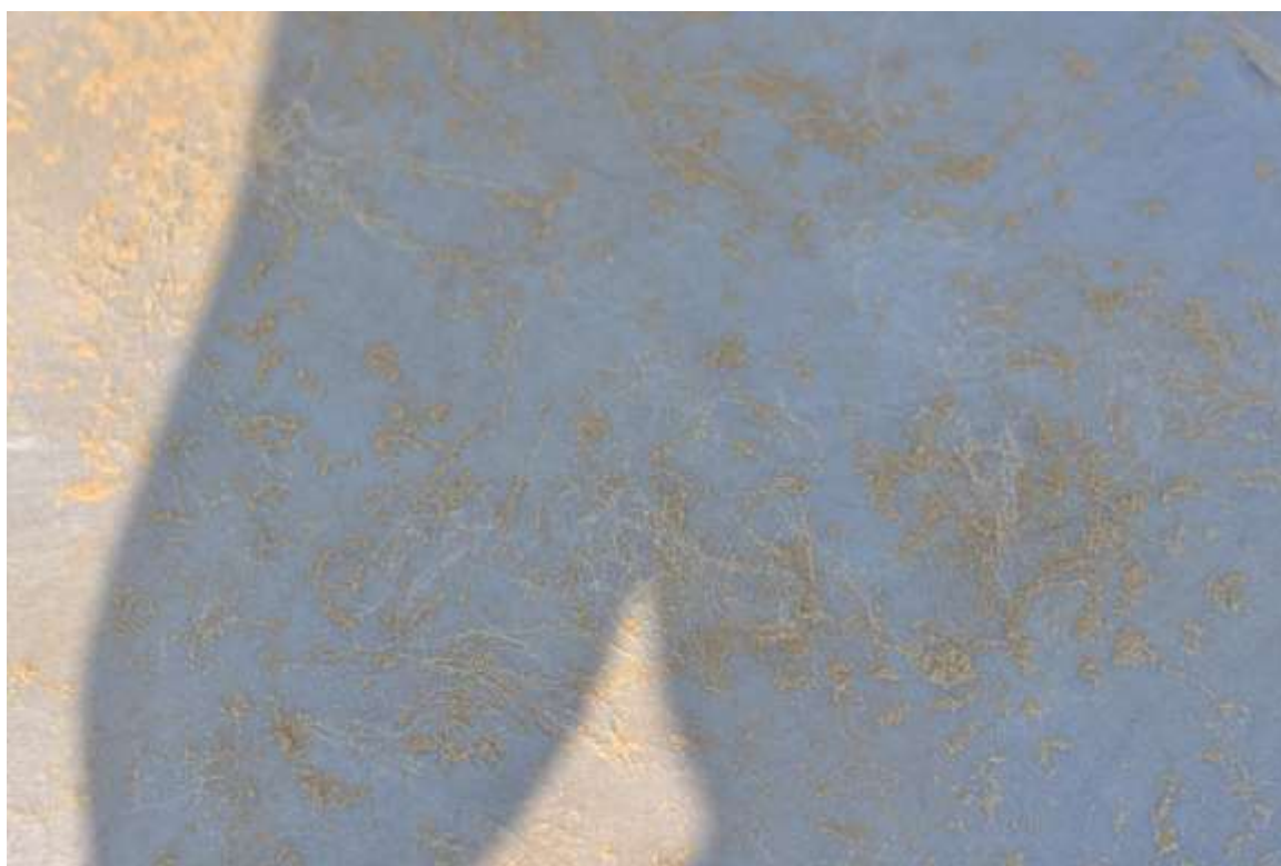
Рисунок 3.12 – Геополотно нетканое после извлечения из конструкции (песок-песок)
