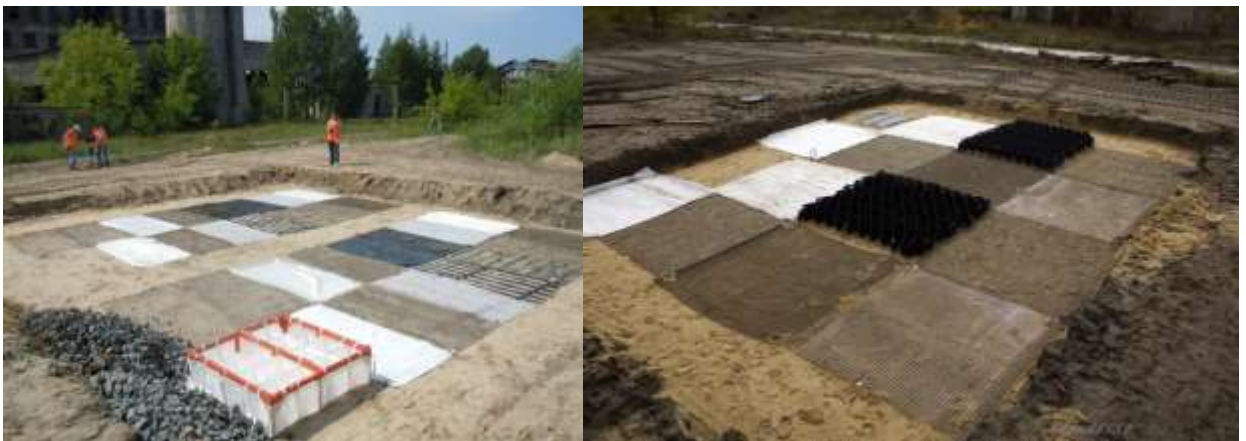
Рисунок 3.10 – Испытательные полигоны с уложенными материалами
