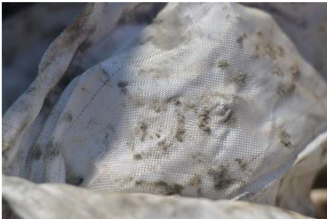
Рисунок 3.11 – Геополотно тканое после извлечения из конструкции (разделение слоев песок-щебень)
