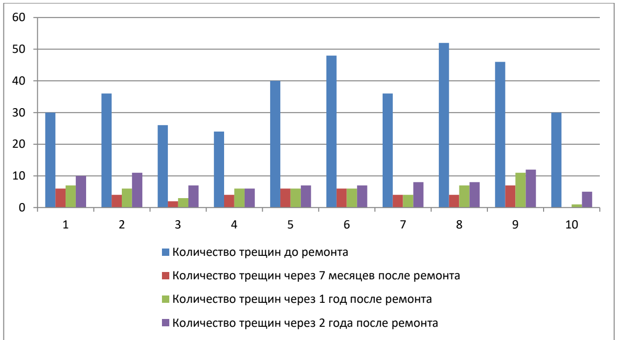
Рисунок 3.24 - Трещины на контрольных участках
