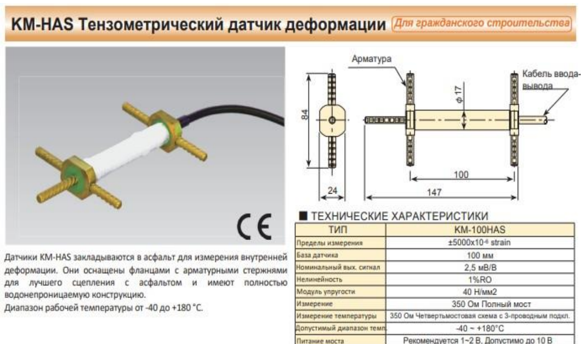
Рисунок 17 - Описание применяемых датчиков деформаций KM-100HAS
