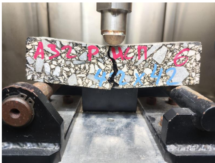
Рисунок 53 – Определение предела прочности на растяжение при изгибе образцов-балочек
