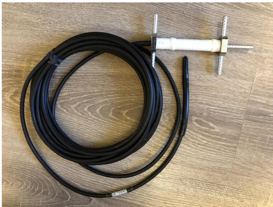
Рисунок 18 – Общий вид применяемых датчиков деформаций KM-100HAS
