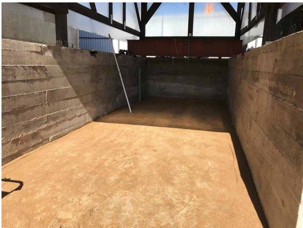
Рисунок 28 - Общий вид слоя из песка после закладки датчиков, обратной засыпки и доуплотнения
