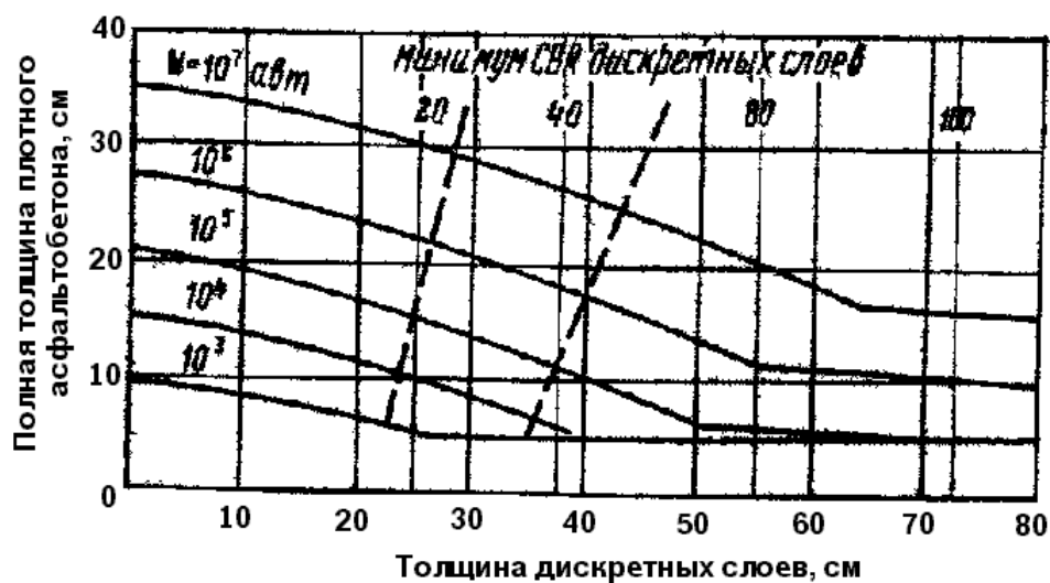
Рисунок 9 – График для расчета толщины дорожной одежды по методу Шелл для разной интенсивности движения по одной полосе при модуле упругости грунта земляного полотна E = 320 \text{ кгс/см}^2 ( CBR = 3 )
