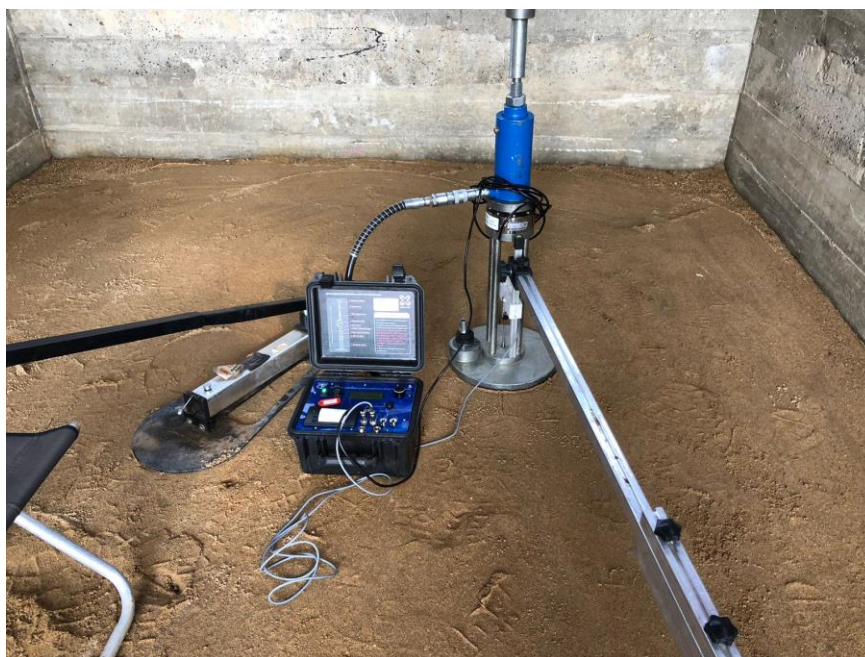
Рисунок 19 - Общий вид установки статического нагружения
