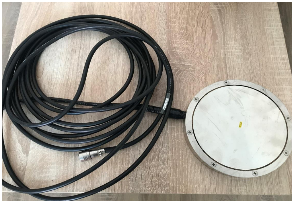
Рисунок 16 – Общий вид применяемых датчиков давления KDA-1MPA
