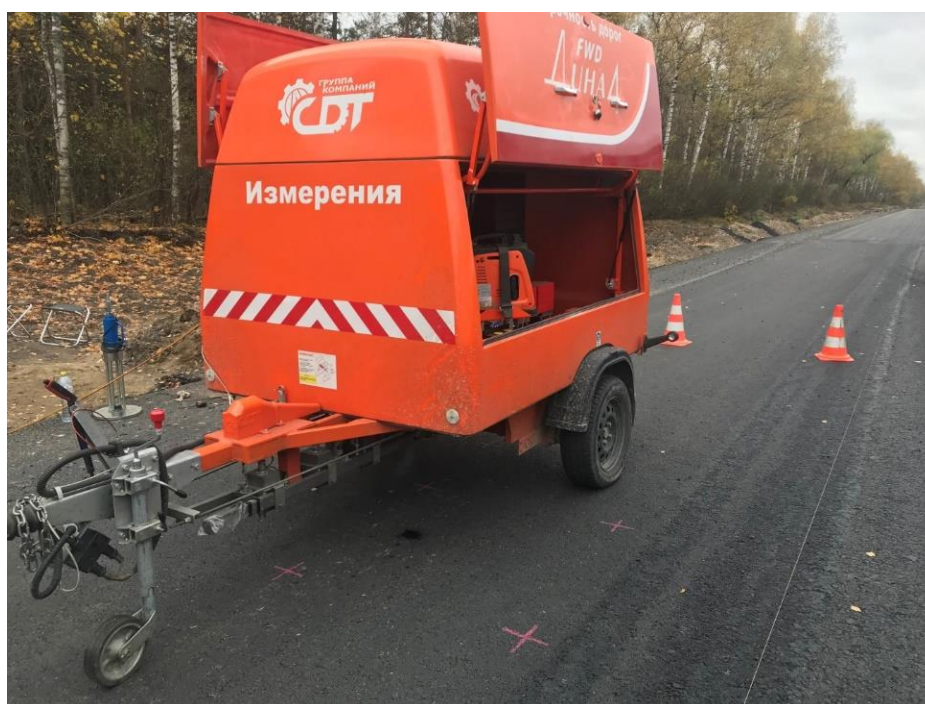
Рисунок 22 - Общий вид установки динамического нагружения FWD «ДИНА-4»
