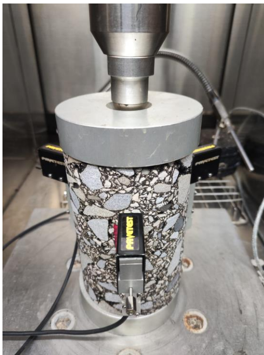
Рисунок 51 – Испытательный модуль в соответствии с установкой АМРТ с подготовленным образцом асфальтобетона и прикрепленными датчиками линейной деформации
