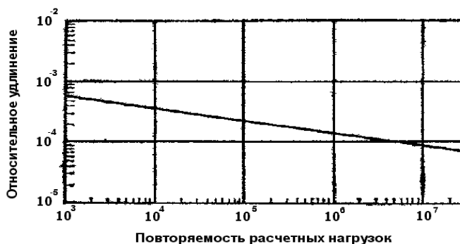
Рисунок 5 – Допустимое удлинение асфальтобетона в зависимости от повторяемости нагрузки (модуль упругости асфальтобетона E = 65000 кгс/см 2 )
