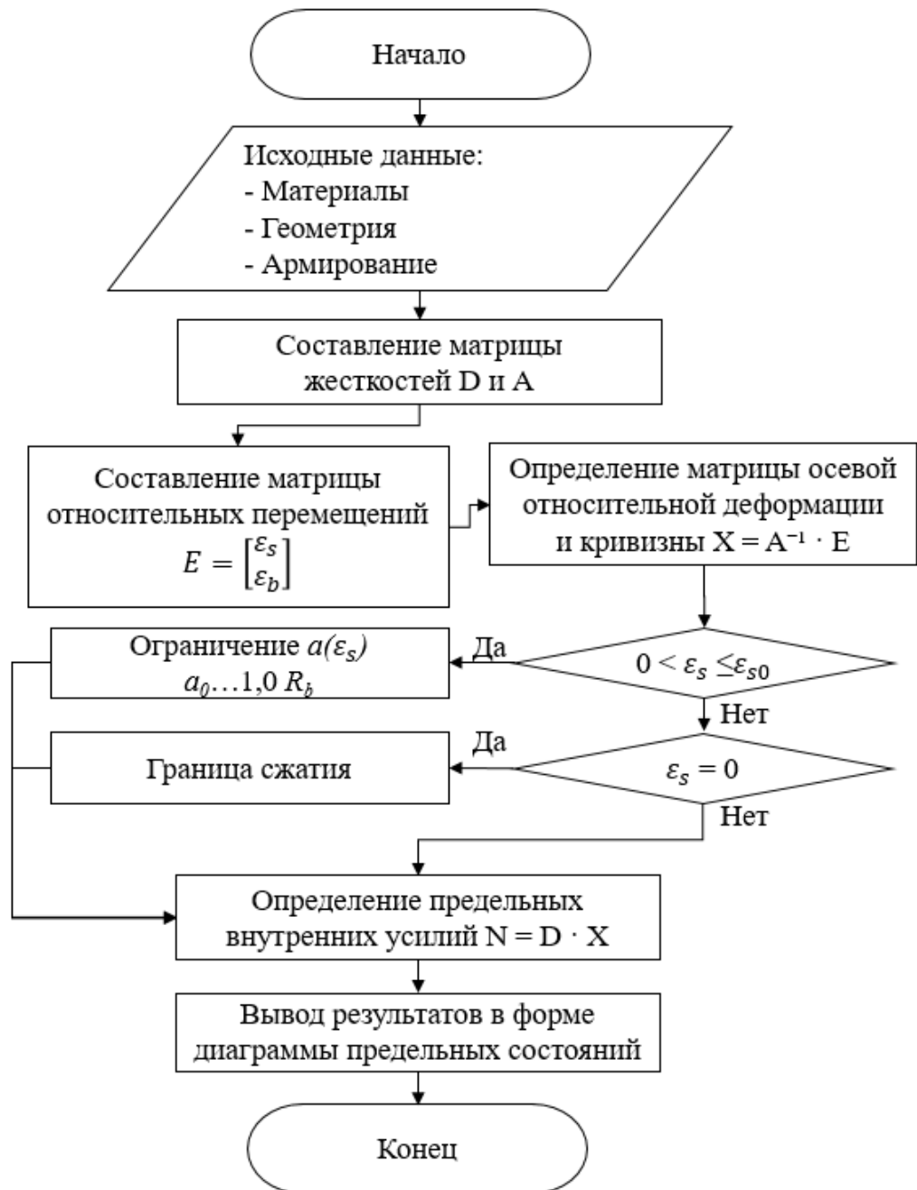
Рисунок 41 – Схема алгоритма построения диаграммы предельных состояний первой группы по условию прочности с учетом ограничений сжатой зоны по нелинейной деформационной модели без итерационных вычислений
