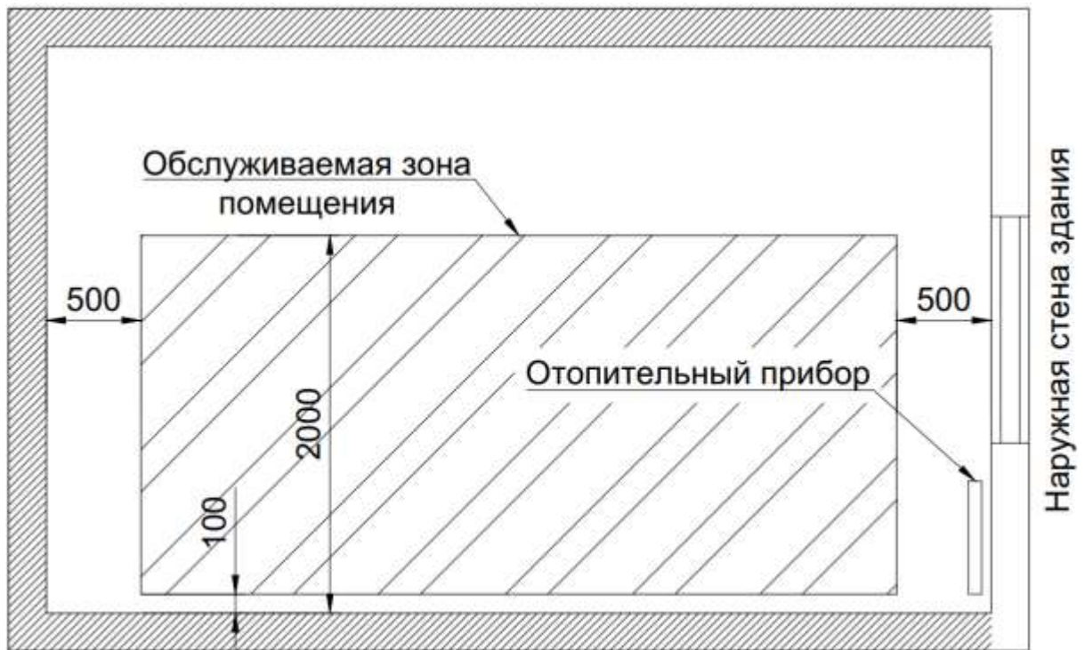
Рисунок 1.4 – Границы обслуживаемой зоны помещения
