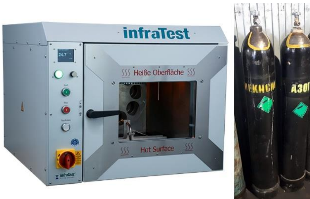
Рис. 2.2 – Испытательная печь RTFOT InfraTest 20-25720 и баллоны с азотом и углекислотой
