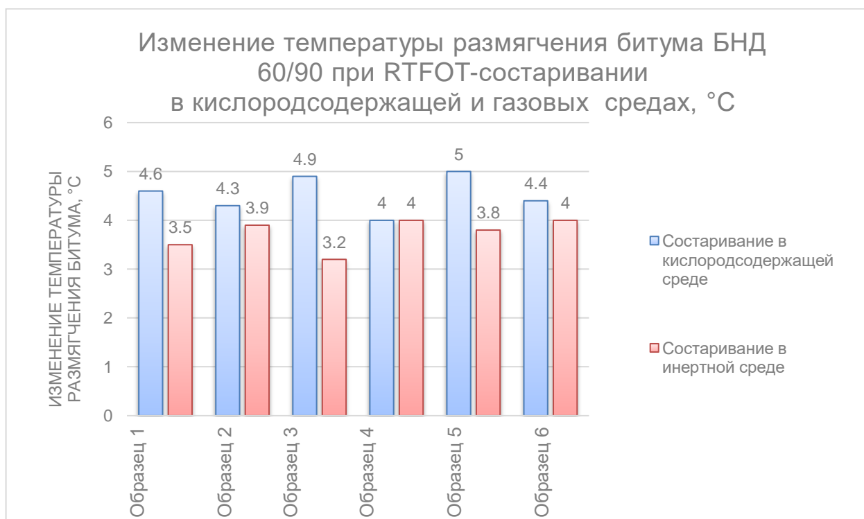
Рис. 3.5 – Изменение температуры размягчения битума БНД 60/90 при RTFOT-состаривании в кислородсодержащей и газовых средах
