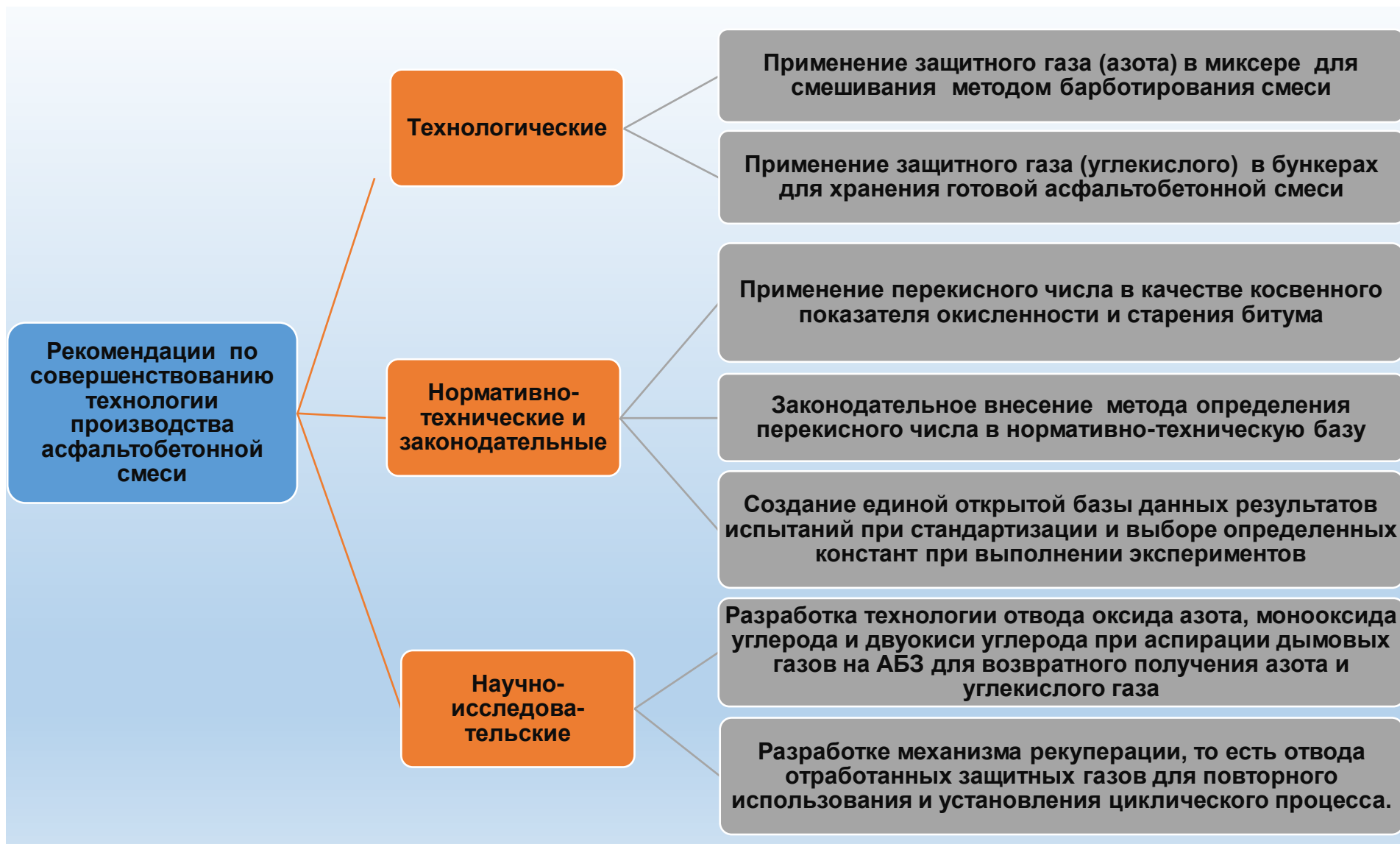
Рисунок 4.10 – Рекомендации по совершенствованию технологии производства асфальтобетонной смеси
