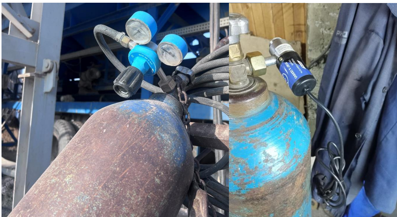
Рисунок 3.29 – Баллон азота с редуктором давления и подогревателем защитных газов ПЭГ-1 220V ПТК
