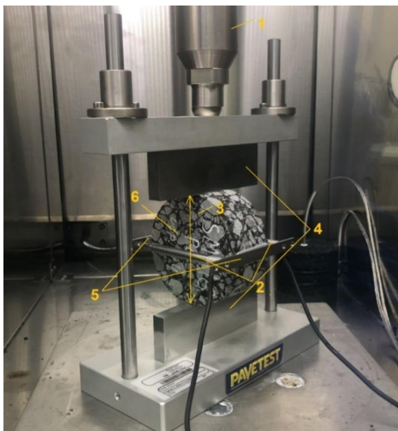
Рисунок 5 – Испытательное устройство для непрямого растяжения (ITFT)
