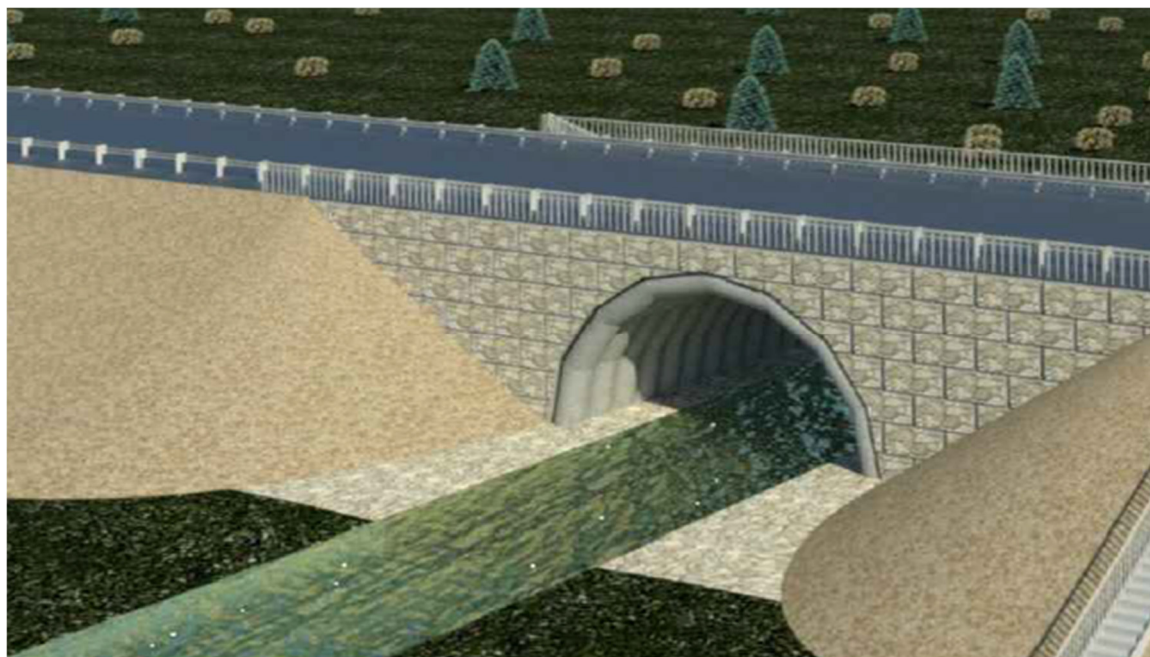
Рис. 6. Грунтозасыпной мост в теле насыпи. Эскиз.
