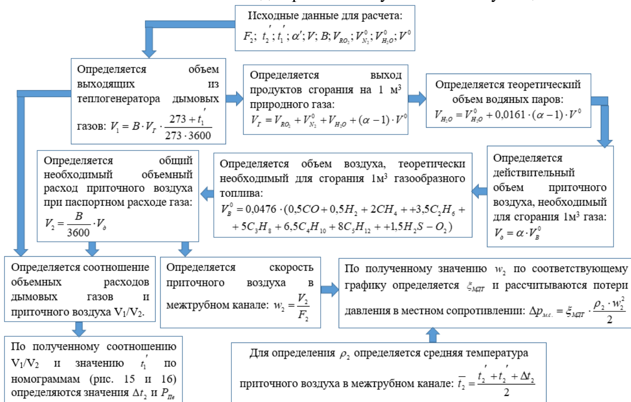
Рис. 14. Алгоритм расчета параметров эффективности внедрения разработанного модифицированного двухтрубного теплообменника
