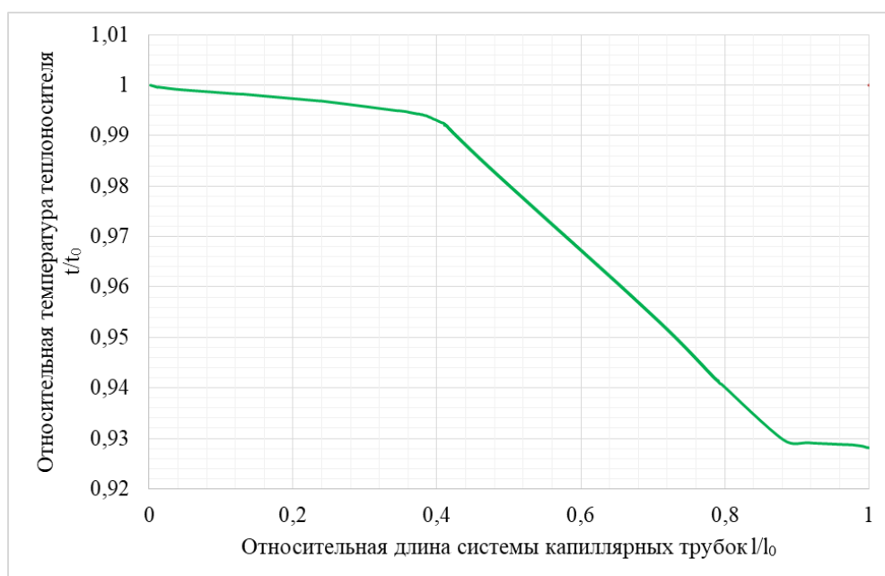
Рис. 7. График снижения температуры теплоносителя ( t_0 = 40\text{ °C} ; l_0 = 5,1\text{ м} )
