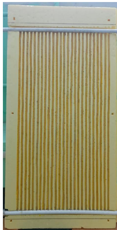
Рис. 16. Общий вид системы капиллярных трубок внутри экспериментального блока
