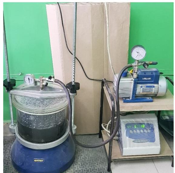
Рисунок 4.5. Вакуумный пикнометр для определения максимальной плотности асфальтобетонной смеси
