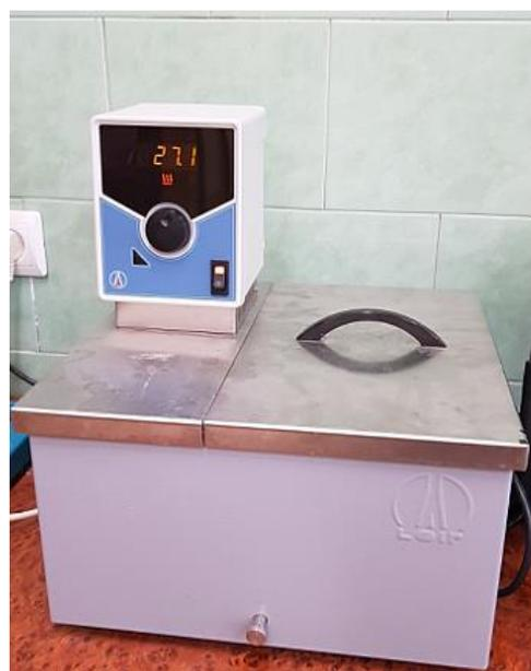
Рисунок 2.9 – Термостат для термостатирования образцов асфальтобетона
