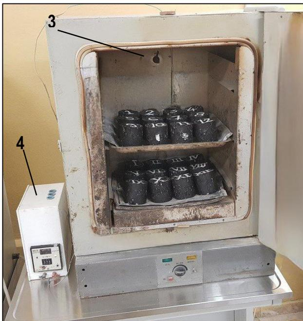
б) Шкаф для имитации теплого и жаркого периода
