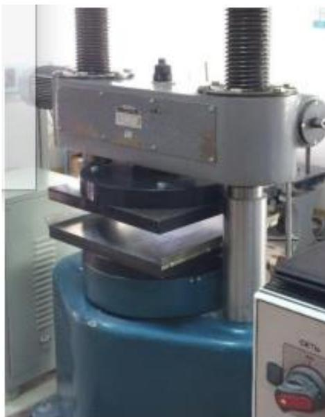
Рисунок 2.6 – Пресс для формования образцов асфальтобетона
