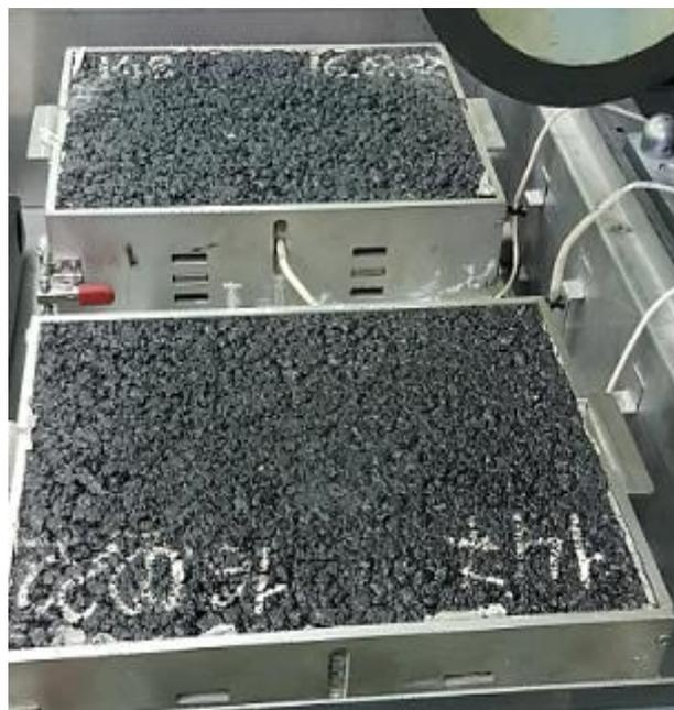
Рисунок 4.7. Плиты для испытания на колеобразование асфальтобетона
