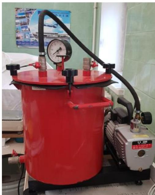
Рисунок 2.8 – Вакуумный прибор для определения плотности образцов асфальтобетона
