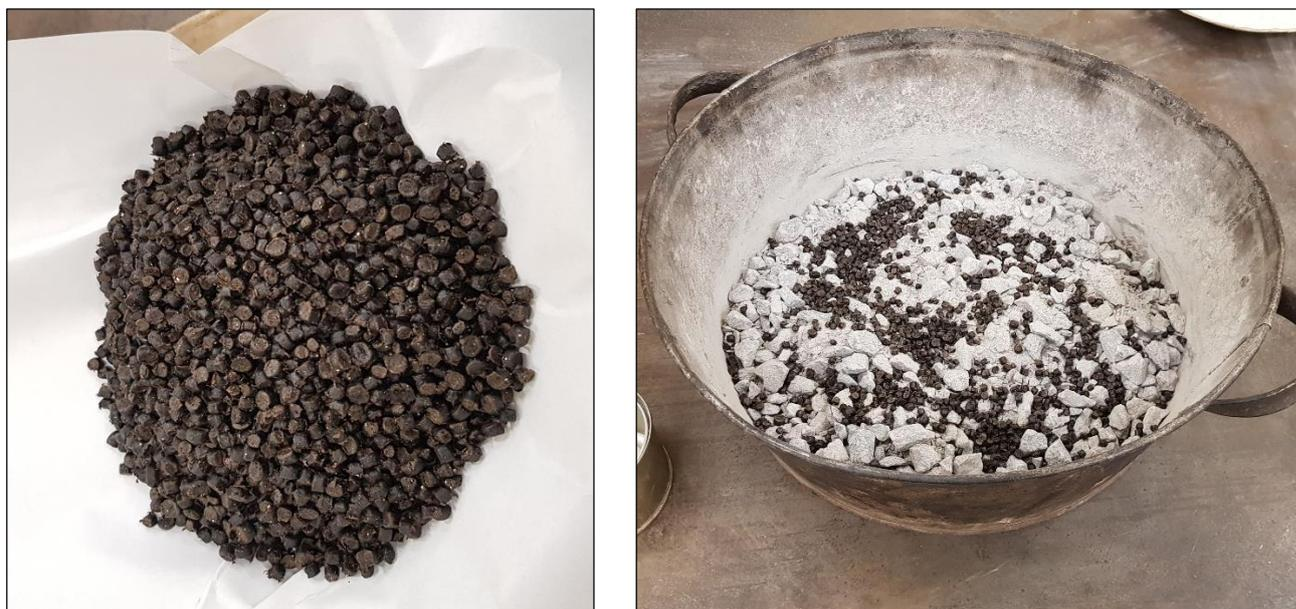
Рисунок 1.8. Модификатор асфальтобетона-резиновый термоэластопласт (РТЭП-М)
