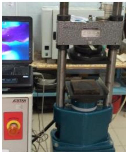
Рисунок 2.7 – Пресс для испытаний образцов асфальтобетона
