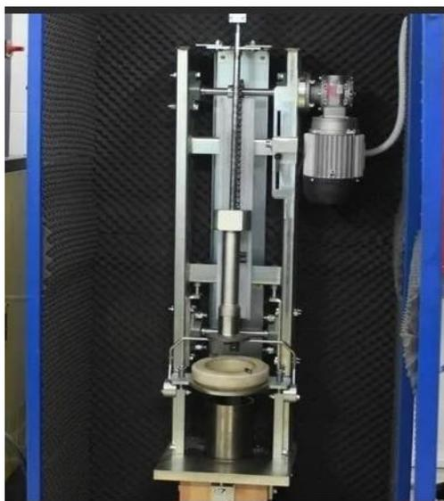
Рисунок 4.4. Автоматический компактор для формирования образцов Маршалла
