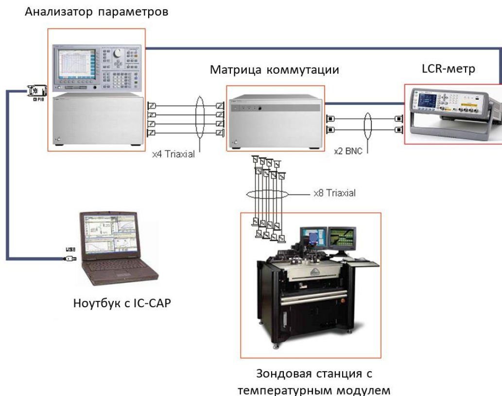
Рис. 2.2 – Блок-схема измерительного комплекса на основе прецизионного анализатора параметров ИС и зондовой станции
