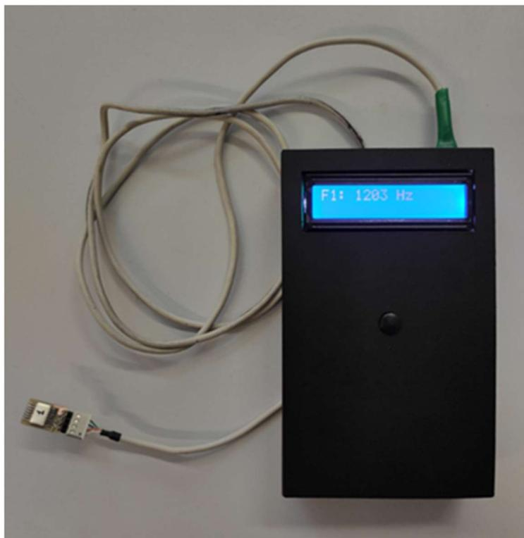
Рисунок 74 – Дозиметр для работы с детекторами с чувствительными элементами на основе р-канальных МНОП-транзисторов.
