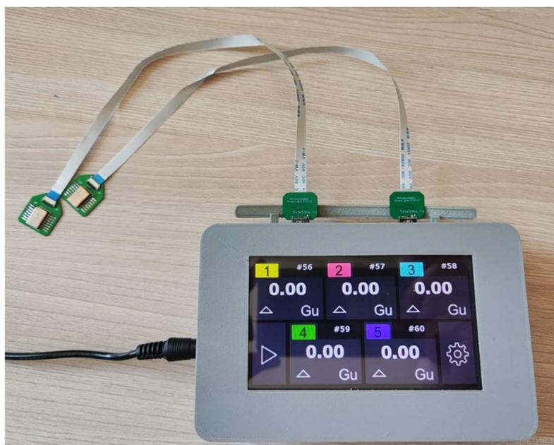
Рисунок 76 – Дозиметр для использования на ОИАЭ и для радиационных испытаний
