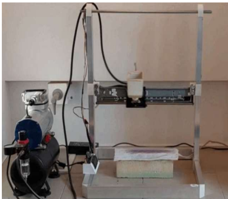
Рисунок 2.5 - Автоматизированная установка спрей-пиролиза УСП-3
