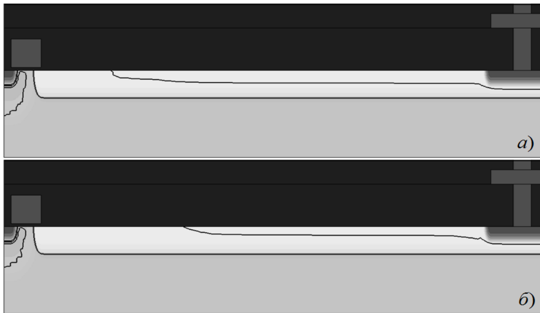
Рис. 3.8. ОПЗ перехода LDD – эпитаксиальная пленка при U_G = 0 : a - U_D = 10 В; b - U_D = 20 В.
