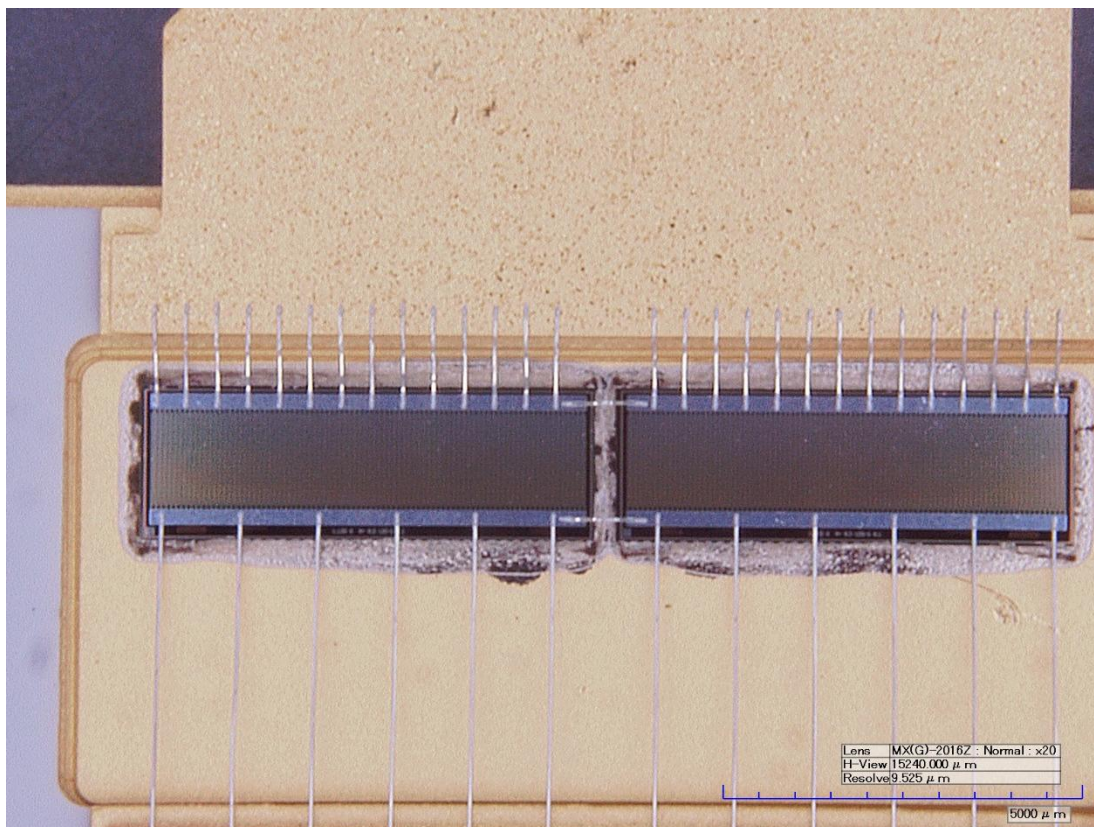
Рис. 4.2. Плечо транзистора 2П9120АС, собранного из кристаллов новой разработки
