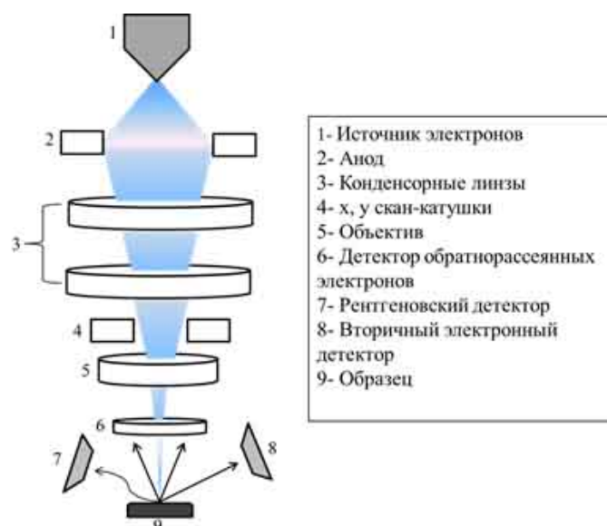
Рисунок 2.13 – Принципиальная схема сканирующей электронной микроскопии (СЭМ) [136]
