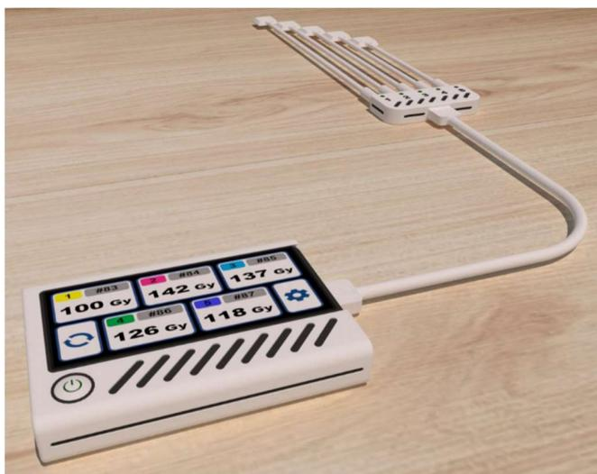
Рисунок 77 – Дозиметр для применения в *in vivo* дозиметрии
