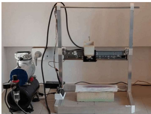
Рисунок 1 - Автоматизированная установка спрей-пиролиза УСП-3
