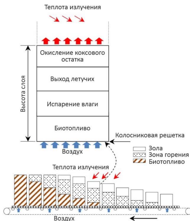
Рисунок 1.2 – Представление горения на движущейся колосниковой решетке [90]
