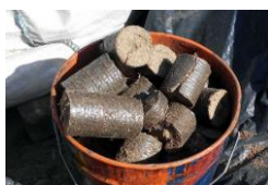
Рисунок 3.2 – Партия брикетированных отходов ТКО (RDF-топливо)
