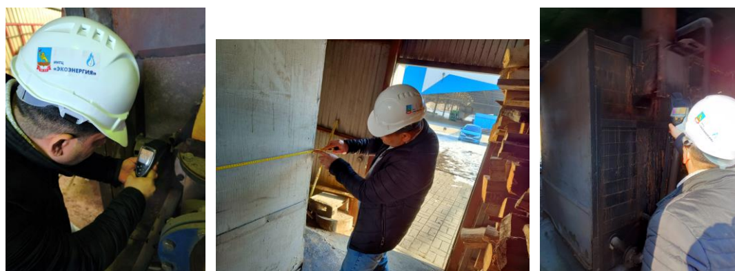
Измерение пирометром температуры поверхности слоя горящего топлива
