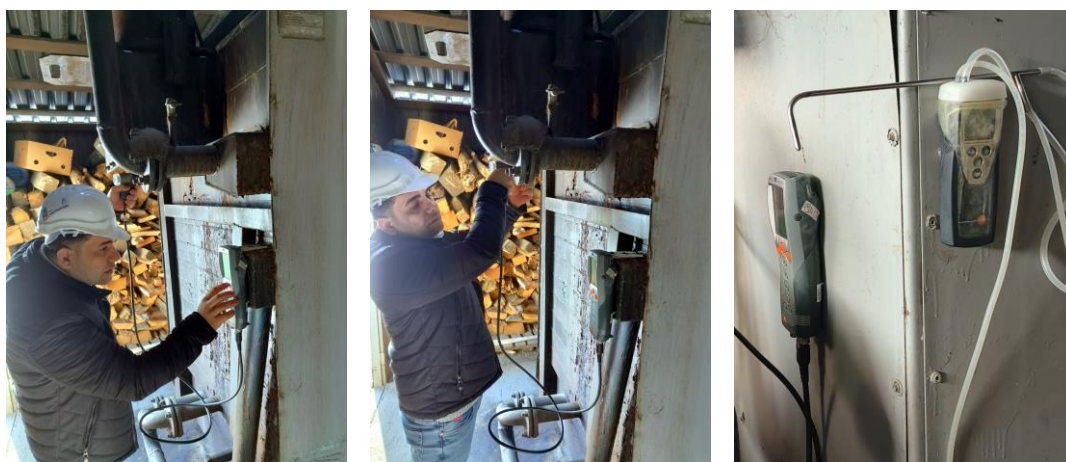
Измерение состава и параметров отходящих газов
