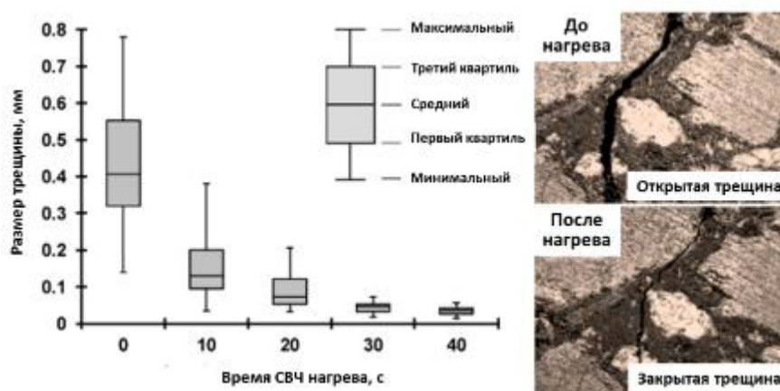
Рисунок 1.10 – Зависимость размера трещин в образцах асфальтобетонной смеси от времени СВЧ нагрева [41]
