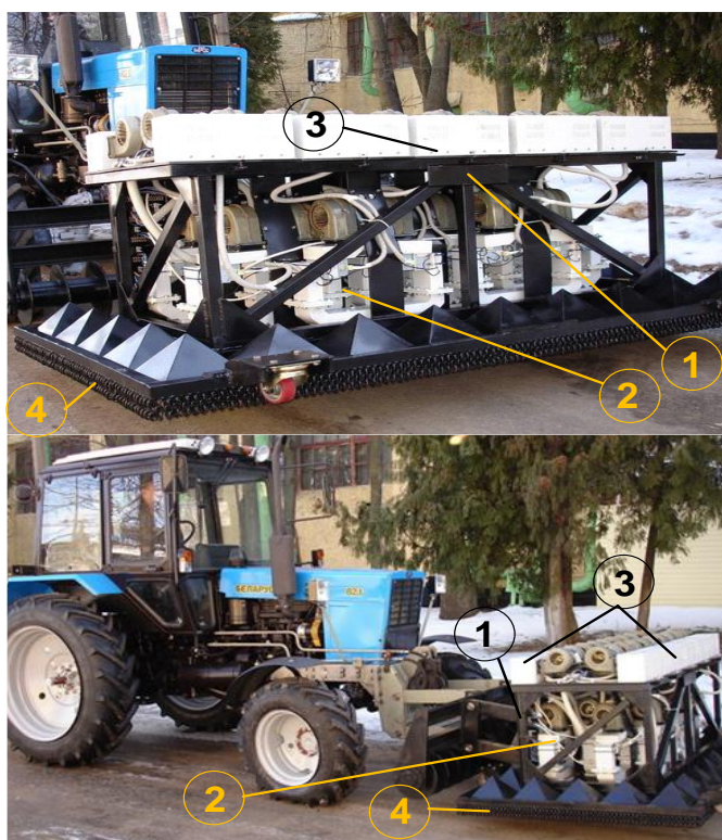
Рисунок 1.7 – СВЧ агрегат, созданный на базе трактора «Беларус»: 1 – рама; 2 – СВЧ модули двухмагнетронные; 3 – блоки питания, сдвоенные; 4 – защитный экран по периметру рамы [34]
