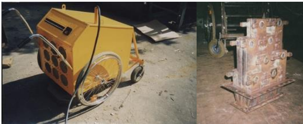
Рисунок 1.6 – Микроволновая установка и излучающий раструб для ремонта трещин асфальтобетонных покрытий [33]
