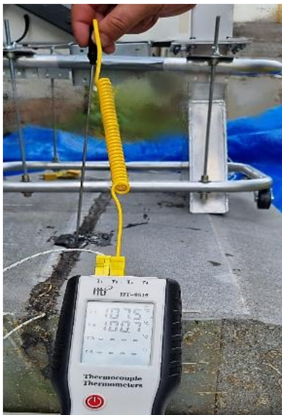
Рисунок 2.13 – Сравнение показаний датчиков температуры открытого и закрытого типа в приповерхностном слое герметика
