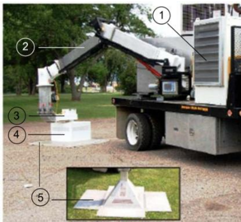
Рисунок 1.5 – СВЧ установка для оттаивания мерзлой земли и ремонта асфальтовых покрытий: 1 – генератор переменного тока; 2 – гидравлический манипулятор; 3 – магнетрон; 4 – рупорная антенна; 5 – защитный экран
