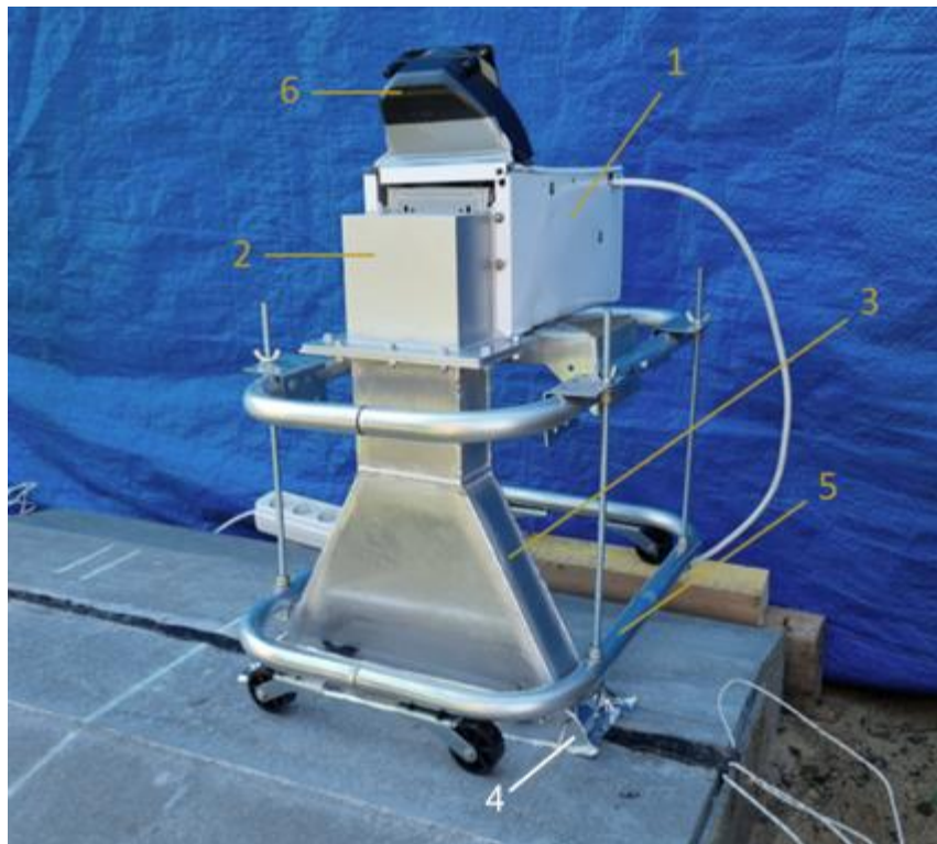
Рисунок 2.8 – Экспериментальная СВЧ установка: 1 – магнетрон с блоком питания; 2 – прямоугольный волновод; 3 – рупорная антенна; 4 – защитный пояс; 5 – подвижный каркас; 6 – кулер
