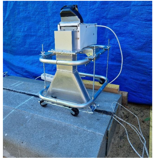
Рисунок 1 - Схема эксперимента (а) и общий вид экспериментальной установки (б): 1 - цементобетонная плита, 2 - деформационный шов, 3 – СВЧ-установка, 4 – температурные датчики, 5 – прибор для измерения температуры, 6 – детектор СВЧ-излучения
