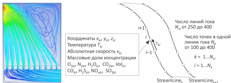
Рисунок 2 – Графическое изображение линий тока (StreamLines) и представление результатов расчета – значений переменных в узлах сетки
