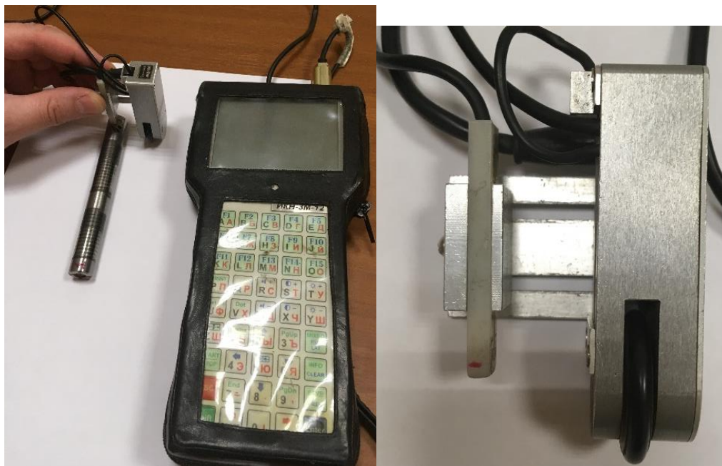
Рисунок 3.14 – Определение зон концентрации напряжений:
