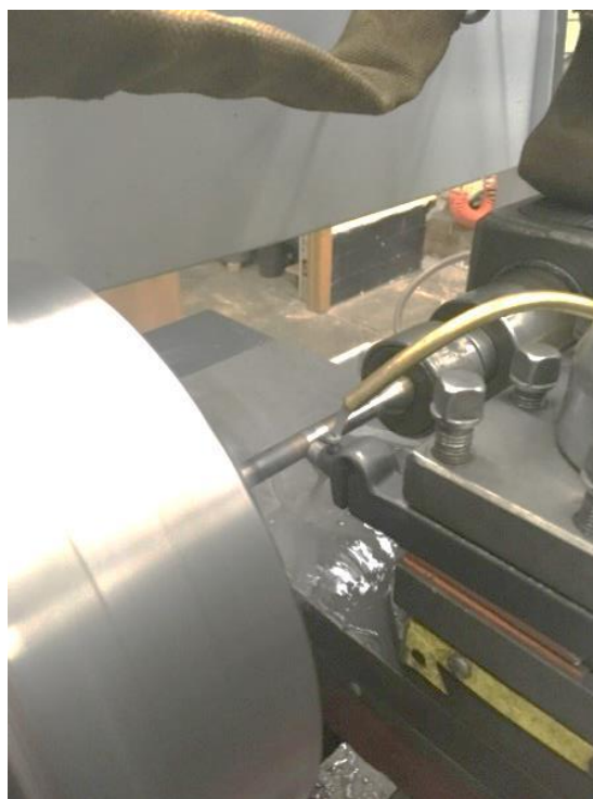
Рисунок 3.7 – Применение СОЖ при алмазном выглаживании
