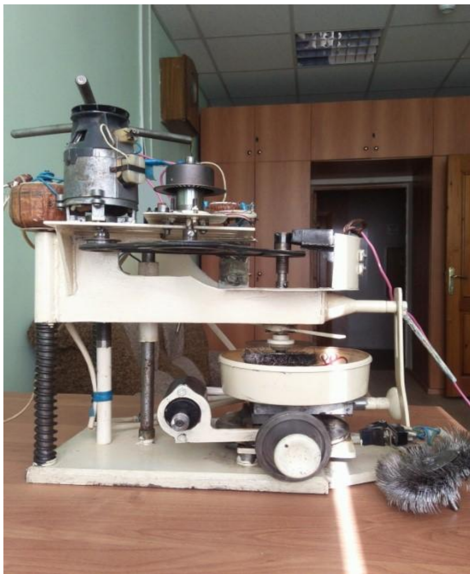
Рисунок 2.1 – Установка для обработки деталей электродом-щеткой
