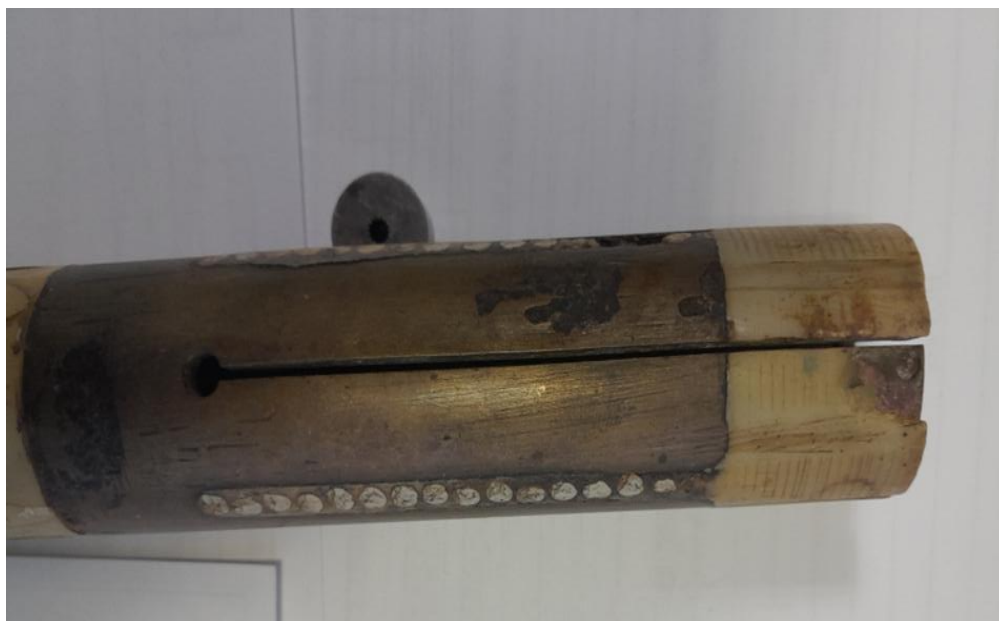
Рисунок 3.1 – Электрод-инструмент (ЭИ) с регулируемым диаметром рабочей части
