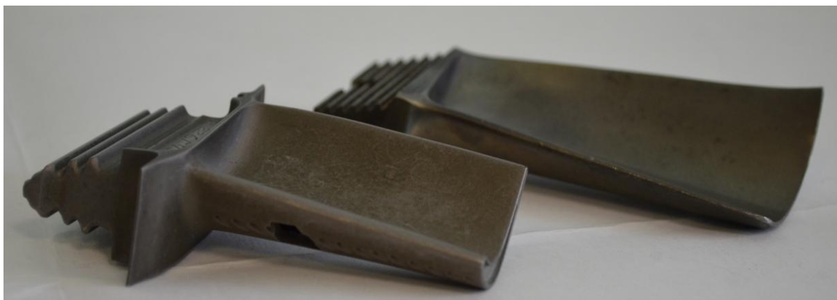
Рисунок 3.11 – Рабочие лопатки турбины авиационного двигателя с продольными охлаждающими отверстиями переменного сечения
