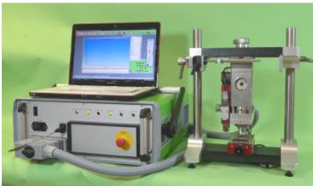
Рисунок 2.8 – Прибор для измерения механических характеристик металлов по диаграмме вдавливания
