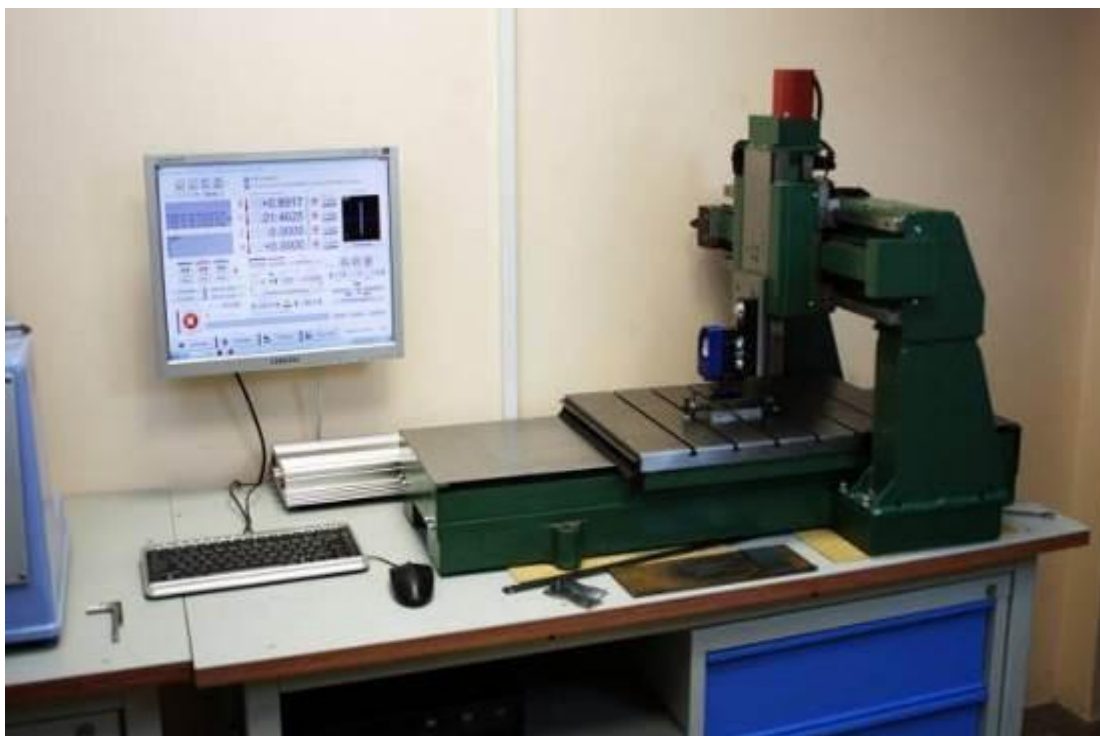
Рисунок 2.2 – Установка для исследования параметров упрочнения пластической деформацией поверхностного слоя
