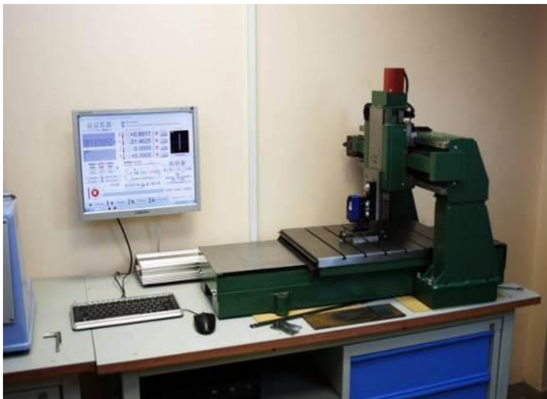
Рисунок 2.3 – Установка для отработки параметров пластической деформации при проектировании режимов комбинированной обработки
