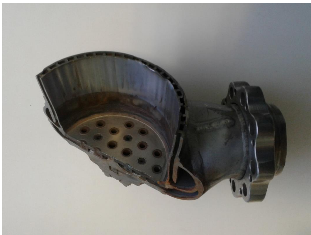
Рис. 4.2 – Узел подачи рабочей среды, включающий форсунки и каналы для подвода топлива
