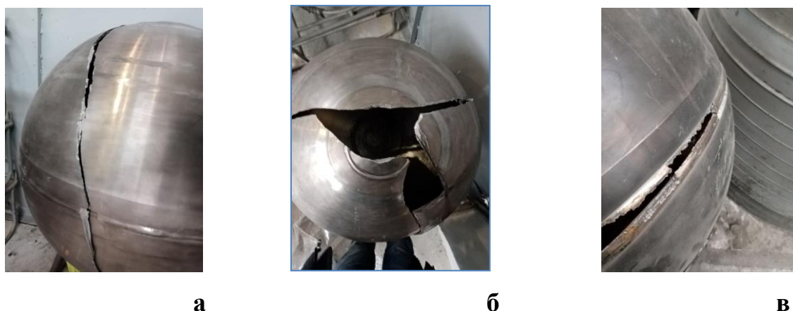
Рис.2.1 – Разрушение при испытаниях баллонов высокого давления а – трещинообразование в направлении перпендикулярном к сварному шву; б – разрушение баллона при импульсном воздействии внутреннего давления; в – разрыв баллона по месту сварки
