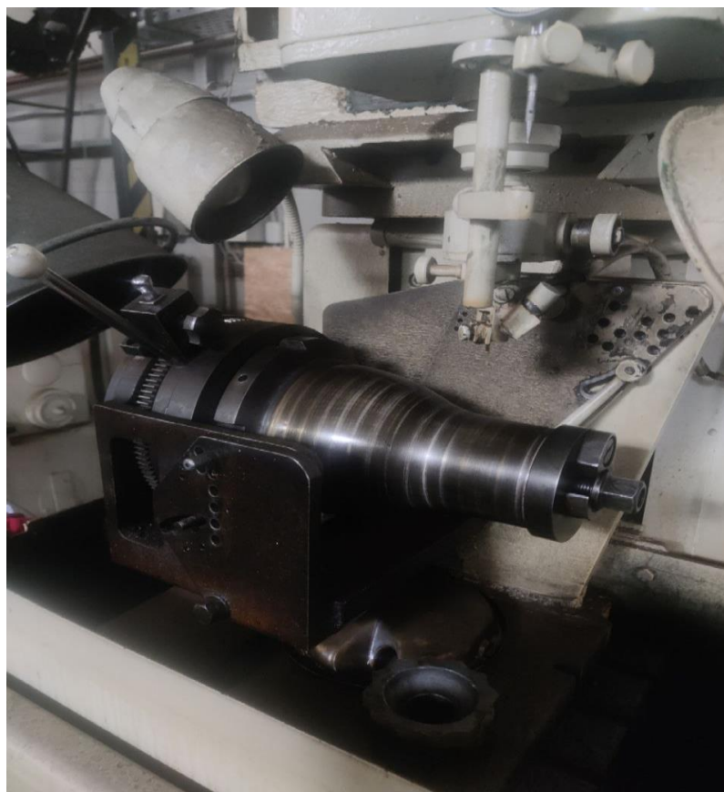
Рисунок 1.9 – Экспериментальный станок и технологическая оснастка для комбинированной многоэлектродной обработки углублений в каналах
