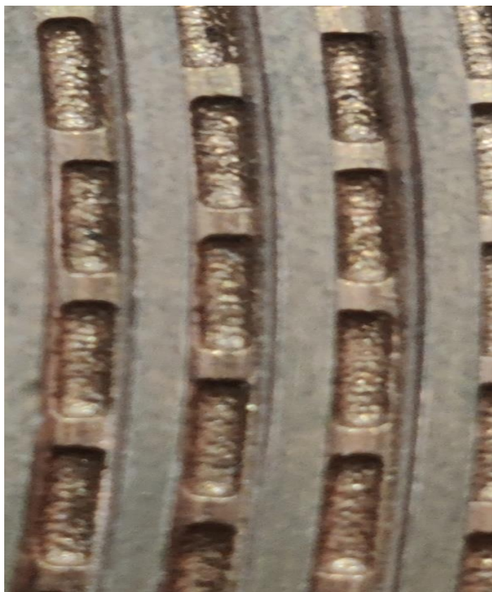
Рисунок 1.8 – Шероховатость углубления в бронзовой детали после электроэрозионной обработки
