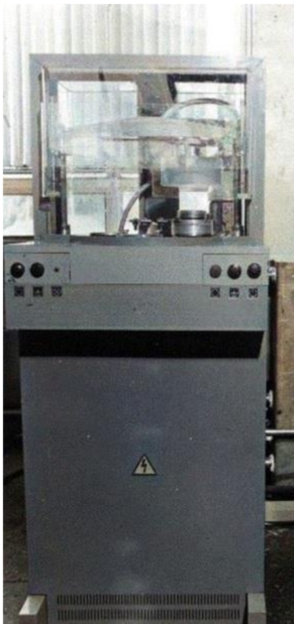
Рисунок 2.1 – Опытно-промышленный станок для комбинированной электрохимической обработки по шаблону
