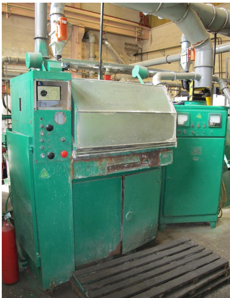
Рисунок 2.3 – Установка для комбинированной обработки углублений, формирующих турбулизаторы в охлаждающих пазах изделий
