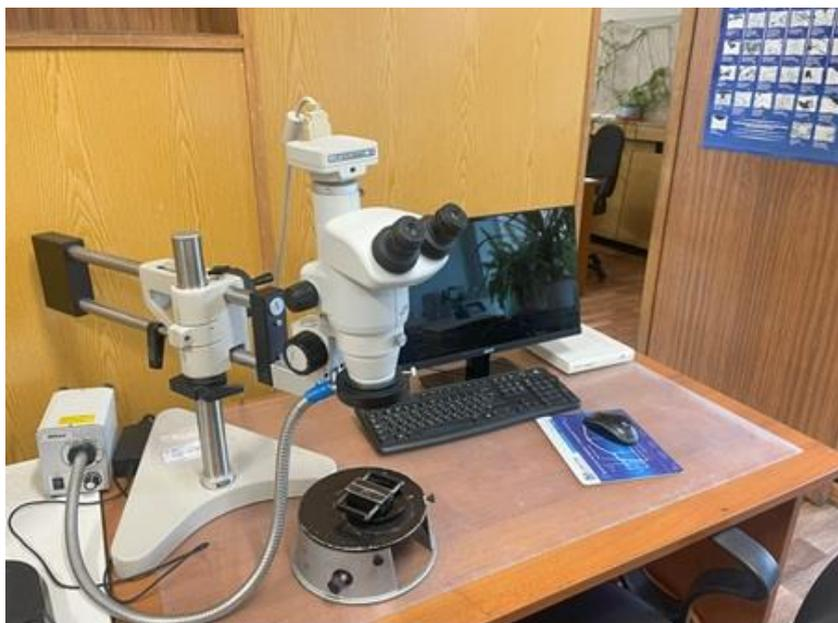
Рисунок 2.7 – Стереоскопический бинокулярный микроскоп для проведения исследований образцов после комбинированной обработки в рабочих средах различного физического состояния
