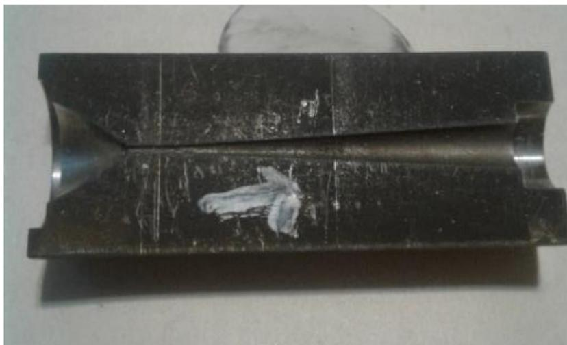
Рисунок 3.5. — Образец канала переменного сечения, полученного при дополнительном подводе тепла в зону обработки
