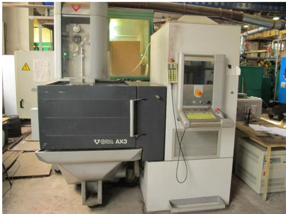
Рисунок 2.3 — Серийный электроэрозионный станок
