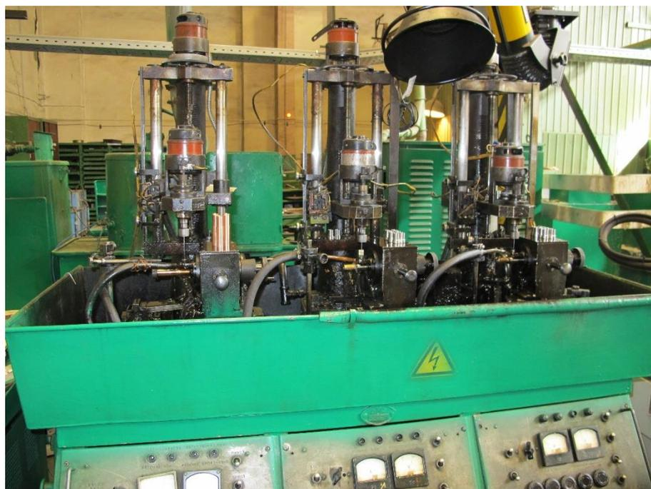
Рисунок 2.1 — Экспериментальная электроэрозионно-химическая установка для комбинированной прошивки отверстий в жидкой рабочей среде
