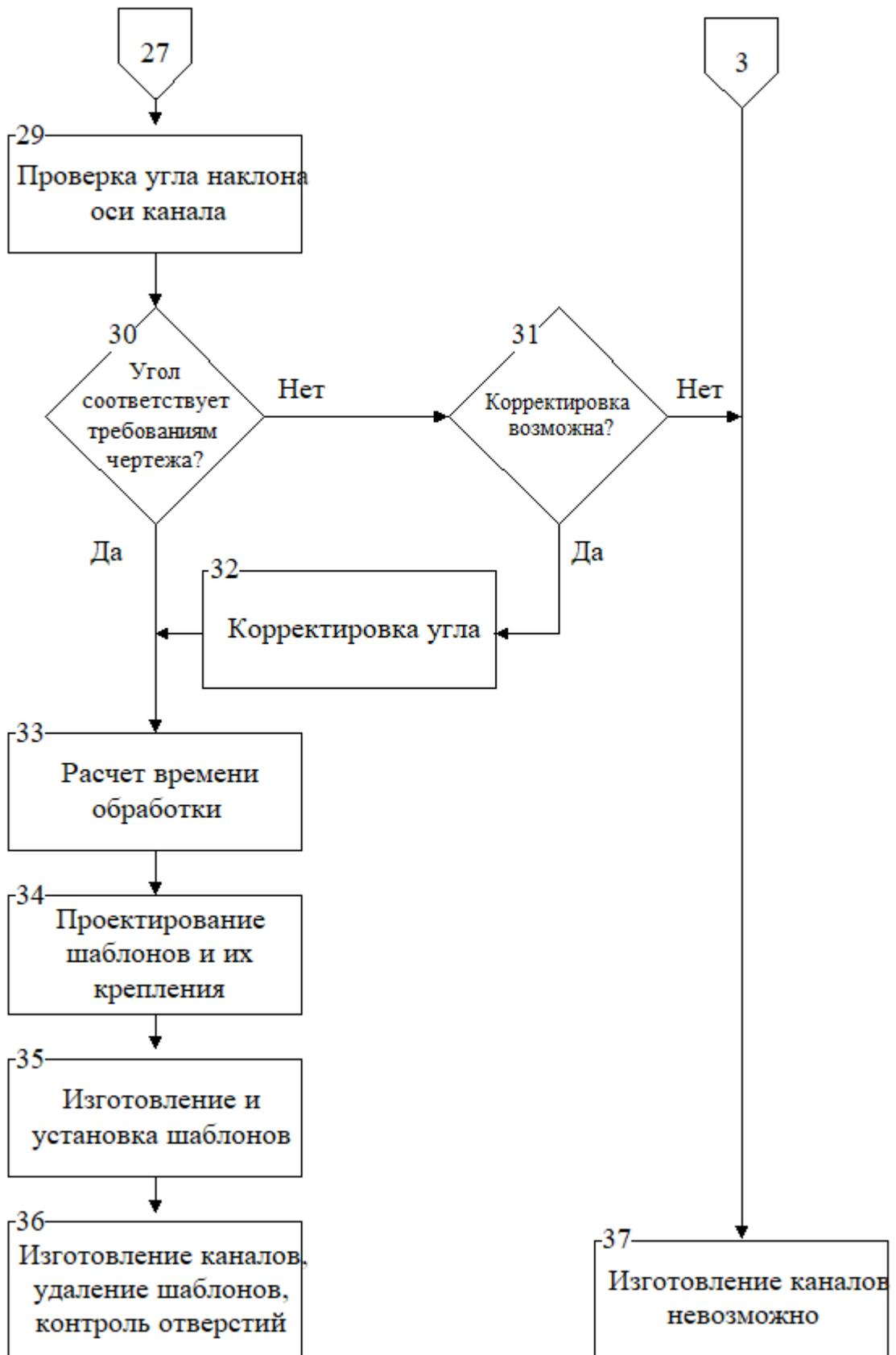
Рисунок 4.2 — Алгоритм проектирования технологического процесса изготовления каналов с использованием технологических сред с переменным состоянием в процессе обработки
