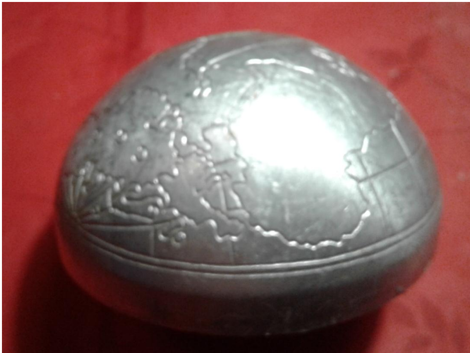
Рисунок 4.9 – Тексты и рисунки, полученные на сферической поверхности детали по фотошаблонам
