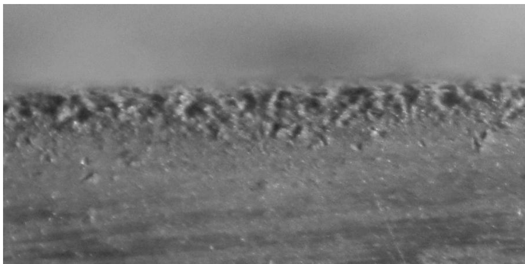
Рисунок 4.13 – Поверхность вдоль контура разделения на кромке детали со стороны входа гидроабразивной струи
