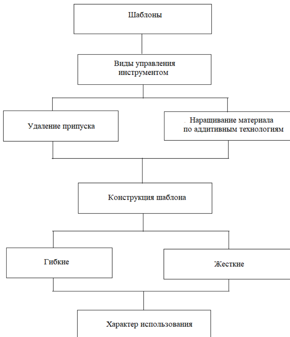
Рисунок 1.1 – Шаблоны, используемые для управления траекторией инструмента в опытном производстве
