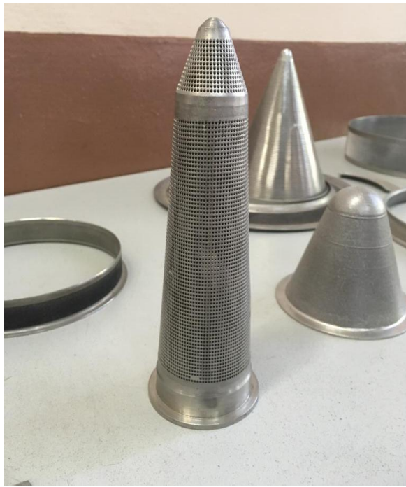
Рисунок 4.5 – Сборные, в том числе многослойные, фильтры ракетных двигателей из нержавеющей стали и латуни, полученные групповым методом по фотошаблонам
