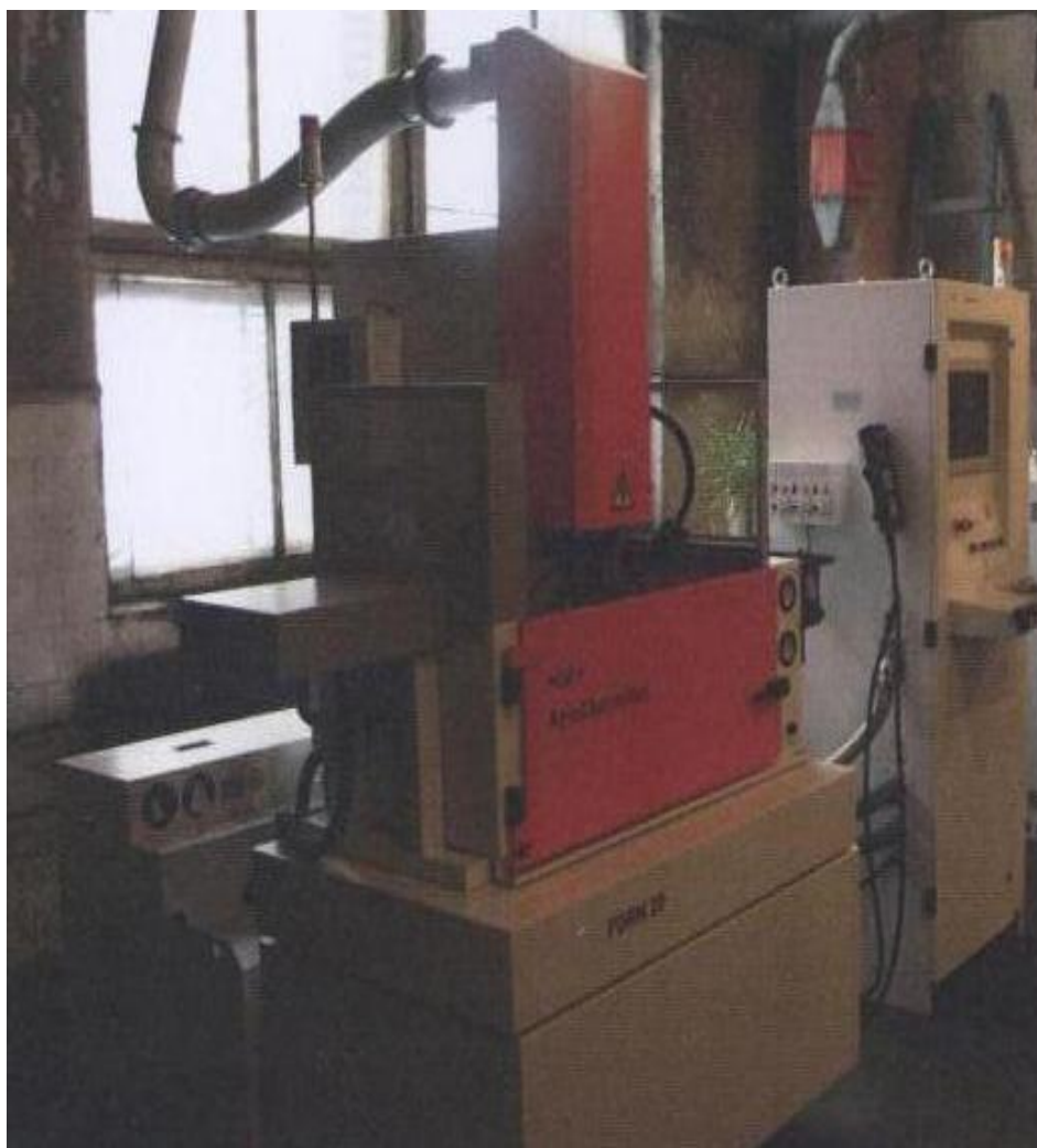
Рисунок 2.2 – Электроэрозионнохимический станок Form 20 фирмы Adie Char millers с управлением вектором действия электромагнитного поля
