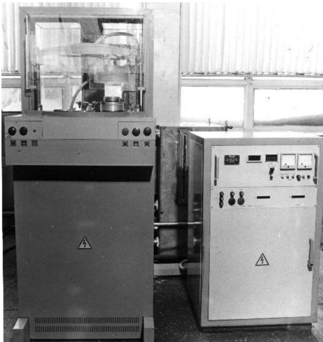
Рисунок 2.1 – Станок для изготовления деталей из листа по фотошаблонам и групповой прошивки отверстий малого сечения
