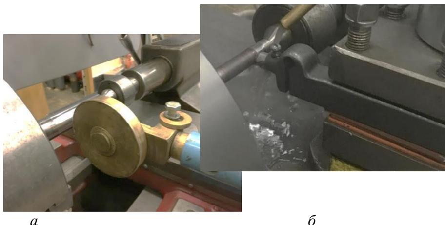
Рисунок 3 – Промышленная установка на базе токарно-винторезного станка модели 16К20: а – электромеханическая обработка; б – алмазное выглаживание
