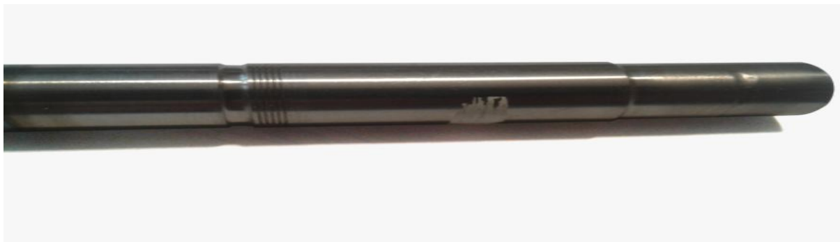
Рисунок 4 – Вал привода из стали 40ХНМА с упрочненной внутренней поверхностью
