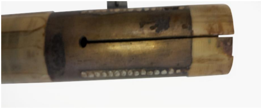
Рисунок 3 – Электрод-инструмент (ЭИ) с регулируемым диаметром рабочей части
