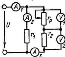
3. Показания, какого из амперметров указаны неправильно, если  $U=150$  В,  $r = 30$  Ом? 1)  $I_1=5$  А. 2)  $I_2=10$  А. 3)  $I_3=5$  А. 4)  $I_4=15$  А.
