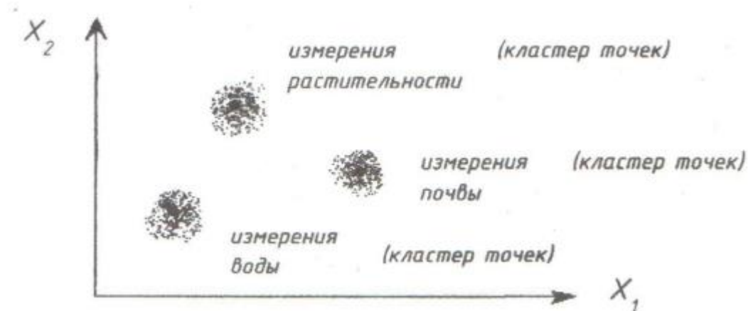
Рис. 2. Распределение в двумерном пространстве измерений земных покровов
