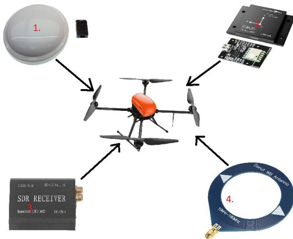
Рис. 3. Схема аппаратного комплекса БПЛА для гибридного мониторинга: 1 - Высокоточный GNSS-приемник, 2 - Инерциальный измерительный блок (IMU), 3 - SDR-приемник, 4 - Низкочастотная рамочная антенна (100-180 кГц)
