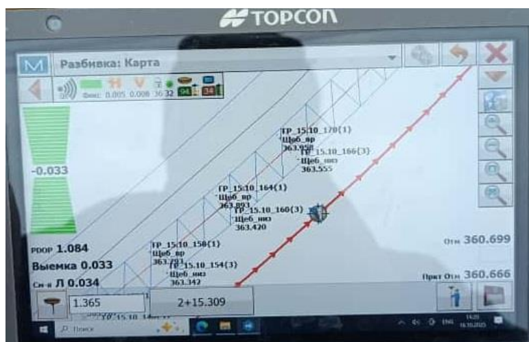
Рис. 4. Пример выноса 3D линии с помощью геодезического GPS-приемника
