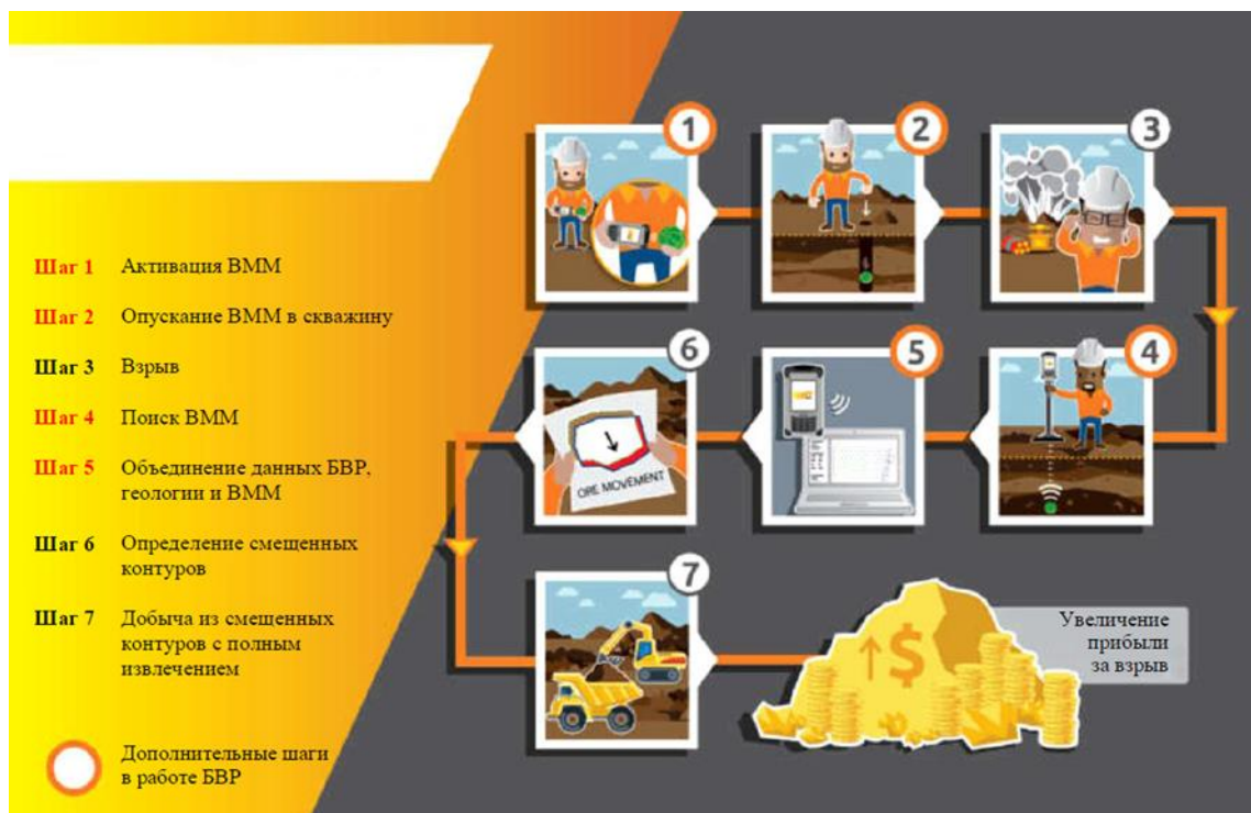
Рис. 2. Технологический цикл системы мониторинга смещений ВММ
