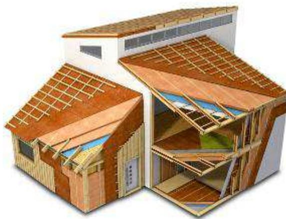
Рис. 2. Конструкция деревянно-каркасного дома
