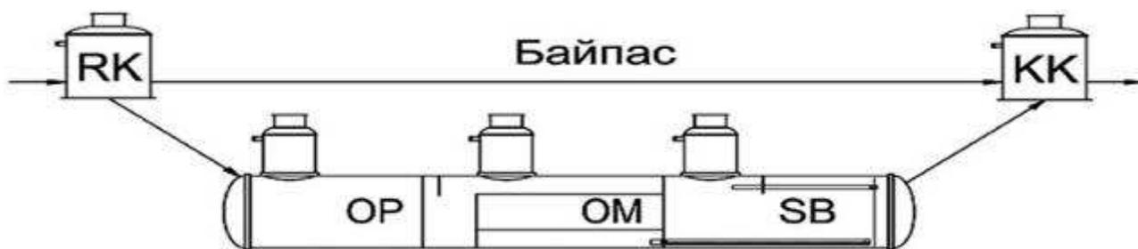
**Рис. 2.** Принципиальная схема ливневой канализации, выполненная в едином корпусе
