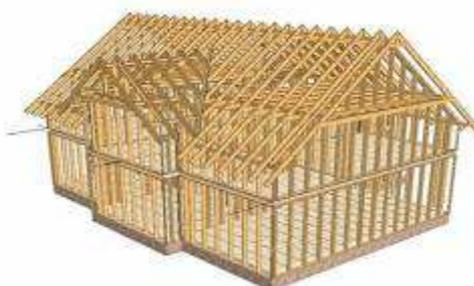
**Рис. 1.** Каркас деревянного дома
