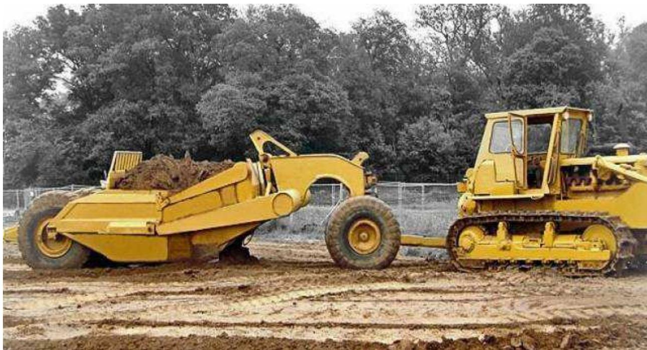
**Рис. 2.** Скрепер прицепной ДЗ -172.1
