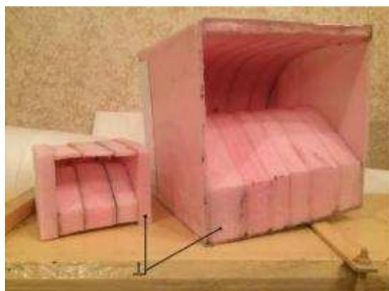
Рис.6. Объемные элементы, выполненные в виде полости, имеющей на лицевой стороне панели отверстие прямоугольной формы
