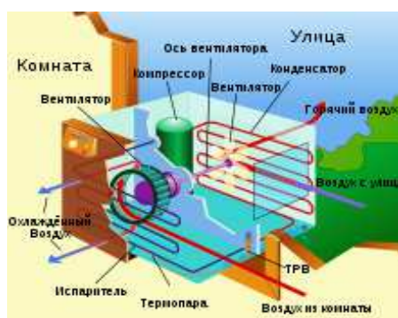
Рис. 8. Устройство кондиционирования воздуха
