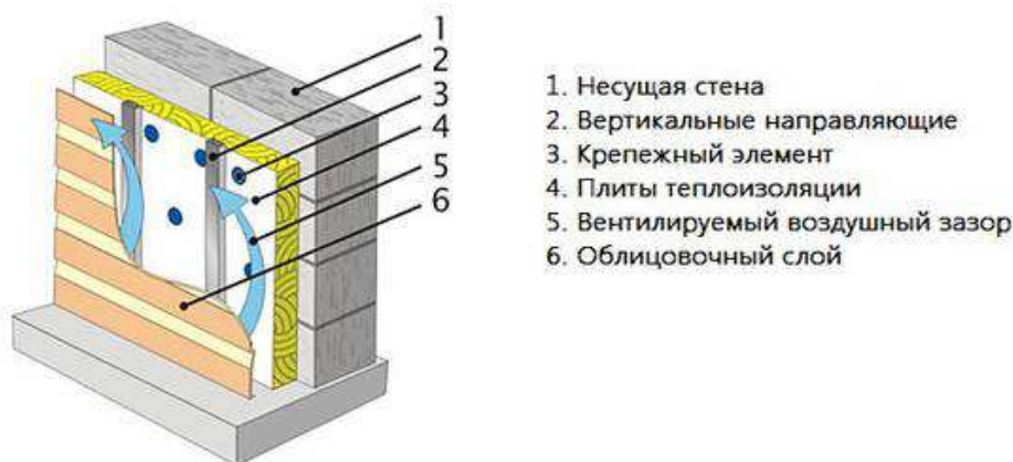
Рис. 3. Стена с вентилируемым фасадом
