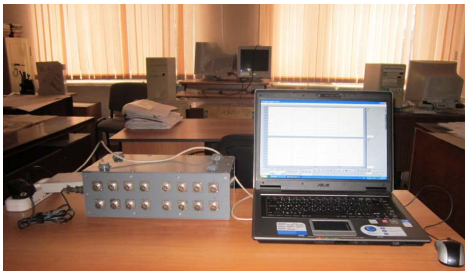
Рис. 2. Общий вид цифровой системы для измерения и регистрации динамических нагрузок в ЗТМ
