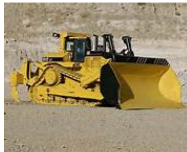
Рис. 4. Конструкции отвалов бульдозеров, обеспечивающих минимальные потери грунта при транспортировании
