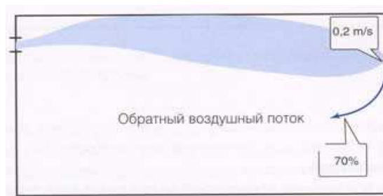
Рис. 7. Обратный воздушный поток при установленном на стене диффузора
