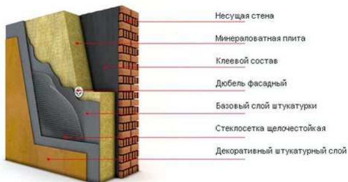
Рис. 2. Устройство штукатурного фасада
