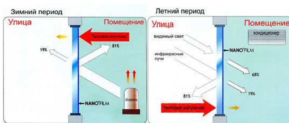
Рис. 1. Отражение инфракрасного излучения стеклом с низкоэмиссионным покрытием
