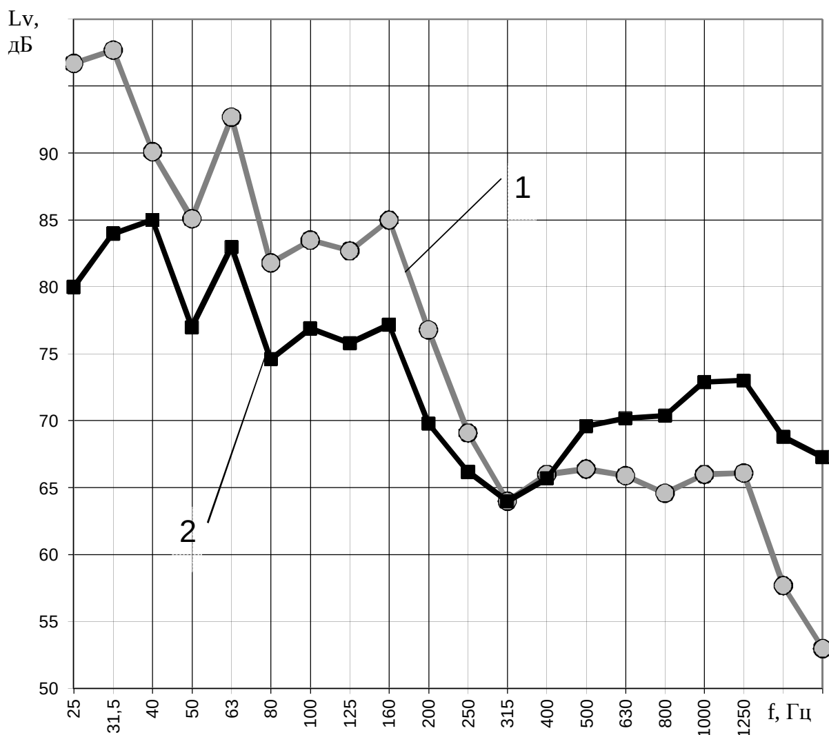
Рис. 1. Вклад воздушного и структурного шума в общее звуковое поле кабины: 1 – структурный шум; 2 – воздушный шум
