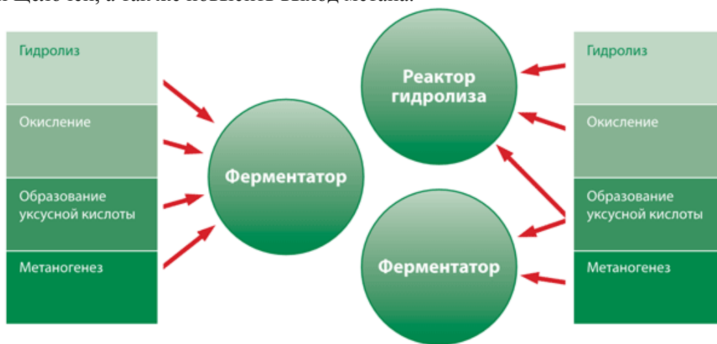
Рис. Одно- и двухстадийная технология производства биогаза
