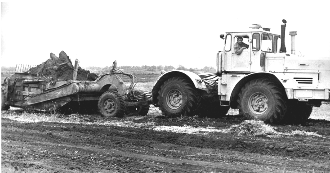
Рис.1. Заполнение ковша увеличенной вместимости ( 10\text{ м}^3 ) с толкачом на суглинистом грунте
