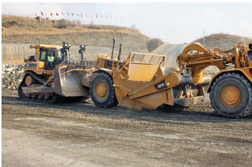
Рис. 1. Трактор-толкач с оборудованием бульдозера
