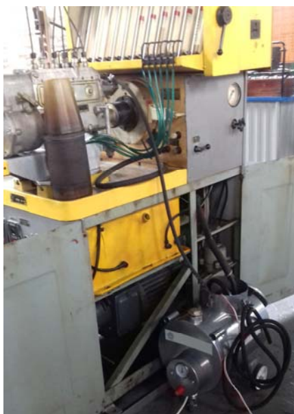
Рис. 2. Моменты испытаний. Установка ТНВД на стенд и подключение к лабораторной установке
