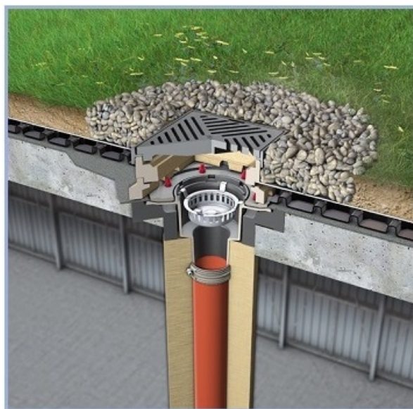
Рис. 1. Воронка внутреннего водостока при инверсионной эксплуатируемой кровле
