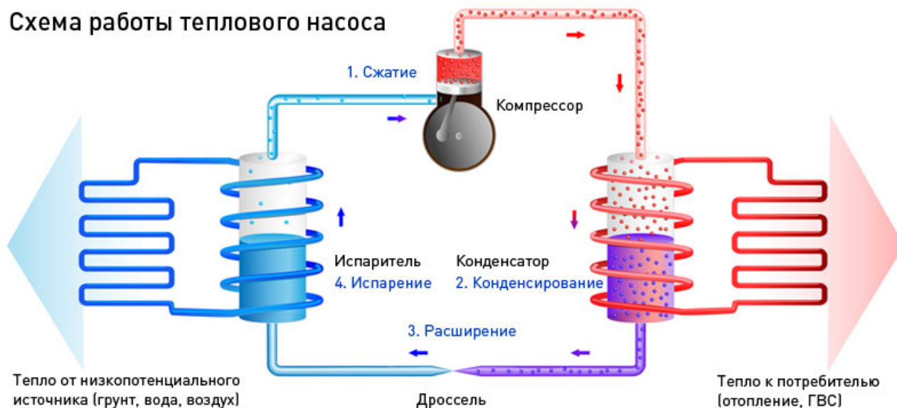
Рис. 3. Схема работы теплового насоса
