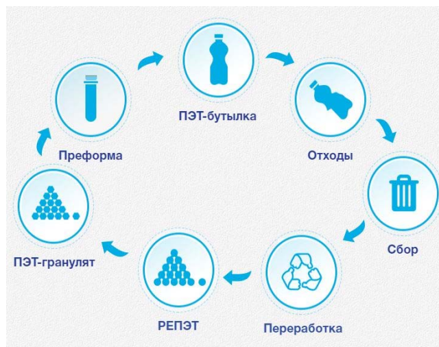
Рис. 4. Рециклинг ПЭТ-бутылок завода по переработке пластмасс «ПЛАРУС» [13]
