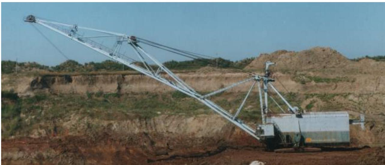
**Рис. 3** ЭШ с кривошипно-рычажным четырехзвенным механизмом шагания
