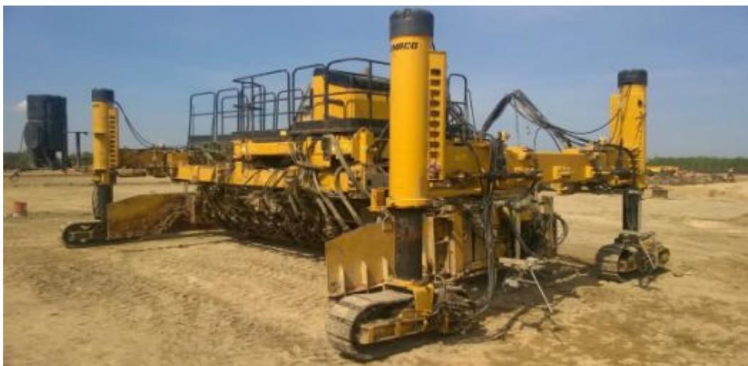
**Рис. 4.** Бетоноукладчик «CommanderIII»
