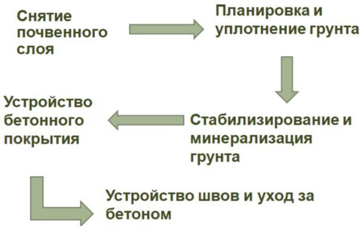
**Рис. 1.** Этапы технологического процесса устройства бетонного покрытия автомобильных дорог
