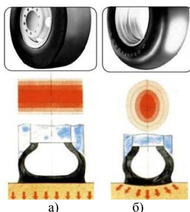
Рис. 4. Общий вид напряжений под действием пневматического катка, оснащенного: а) гладкопрофильными и б) стандартными шинами
