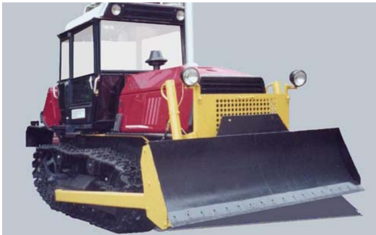
Рис. 3. Трактор Т-4А с бульдозерным оборудованием ОБГН-4
