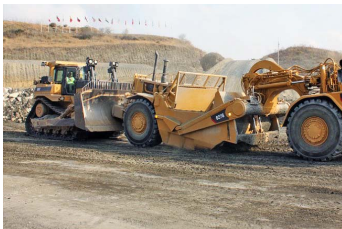
Рис. 1. Трактор-толкач с оборудованием бульдозера
