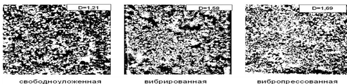
Рис. 4. Изменение структуры мелкозернистого бетона при применении различных видов внешних воздействий
