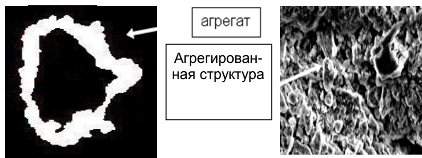
Рис. 2. Структура обводненной частицы цемента (x3000) и системы «цемент-вода» (x1000) при В/Ц=0,2
