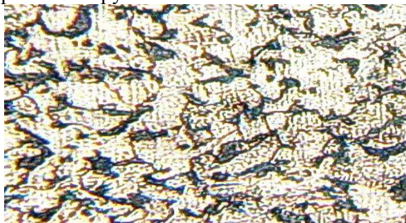
Рис. 1. Структура стали 20 в состоянии поставки (x120)
