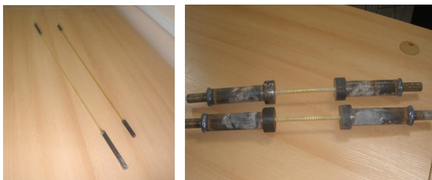
Рис. 5. Внешний вид арматурного стержня с испытательными муфтами
