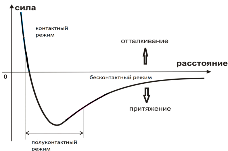
Рис. 2. График зависимости силы Ван-дер-Ваальса от расстояния между кантилевером и поверхностью образца
