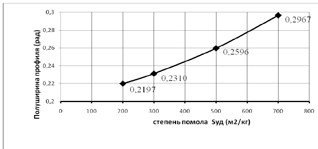
Рис 6. Зависимость полуширины профиля от степени помола Ca_3(SiO_4)O S_{уд} . (300, 500, 700 m^2/kg )
