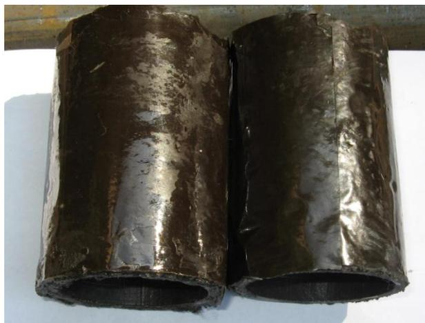
**Рис. 5.** Внешний вид защитного покрытия после структурообразования каучуковой мастики
