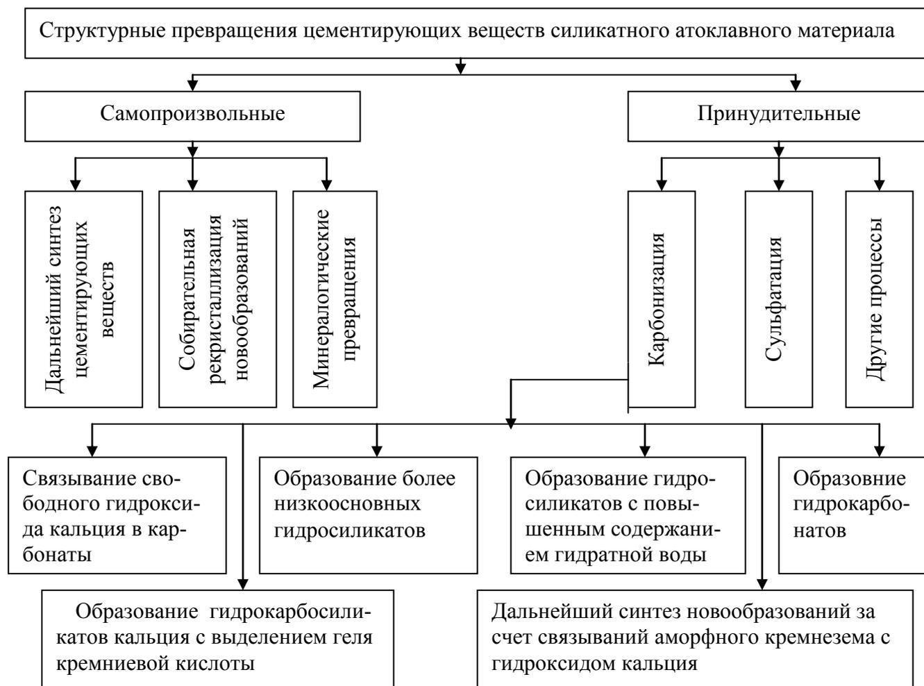
Рис. 1. Схема структурных превращений цементирующих веществ силикатного автоклавного материала
